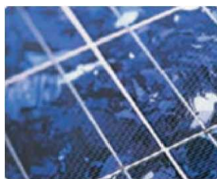
Σχήμα 2.11: Τυπικό φωτοβολταϊκό στοιχείο πολυκρυσταλλικού πυριτίου.
