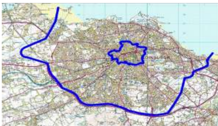
Σχήμα 2.34: Εσωτερικός και εξωτερικός κλοιός χρέωσης στο Εδιμβούργο Πηγή: Rey et al., 2008
