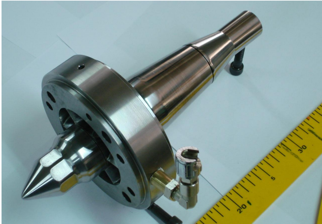
Σχήμα 2.12 Άποψη της μήτρας χωρίς τα εξωτερικά τμήματα, στην έξοδο του ρευστού
