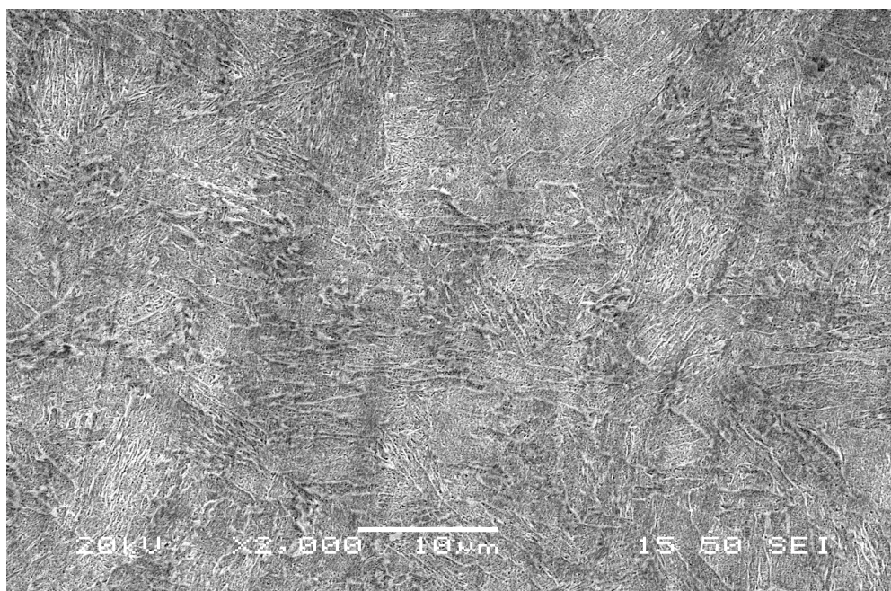
Εικόνα 49. Ηλεκτρονική μικρογραφία δευτερογενών ηλεκτρονίων (SEM) της μικροδομής μη ελασμένου δοκιμίου μετά από γήρανση στους 485 °C για 200 ώρες
