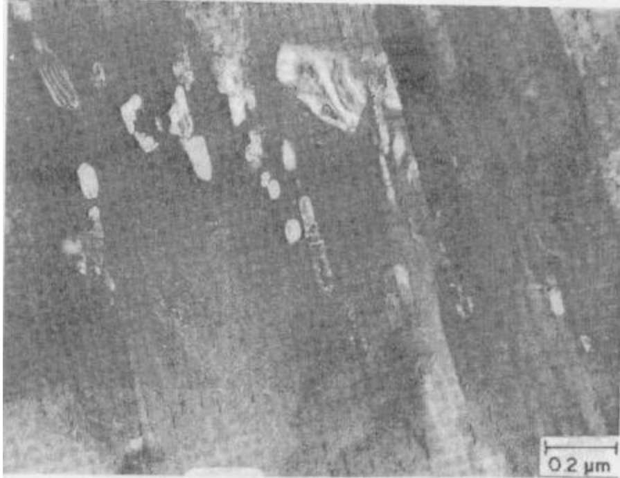
Εικόνα 22. Η φάση του ωστενίτη στα όρια των κεραμιδίων του μαρτενσίτη, στο δοκίμιο υπεργήρανσης στους 640°C για δύο ώρες [13].
