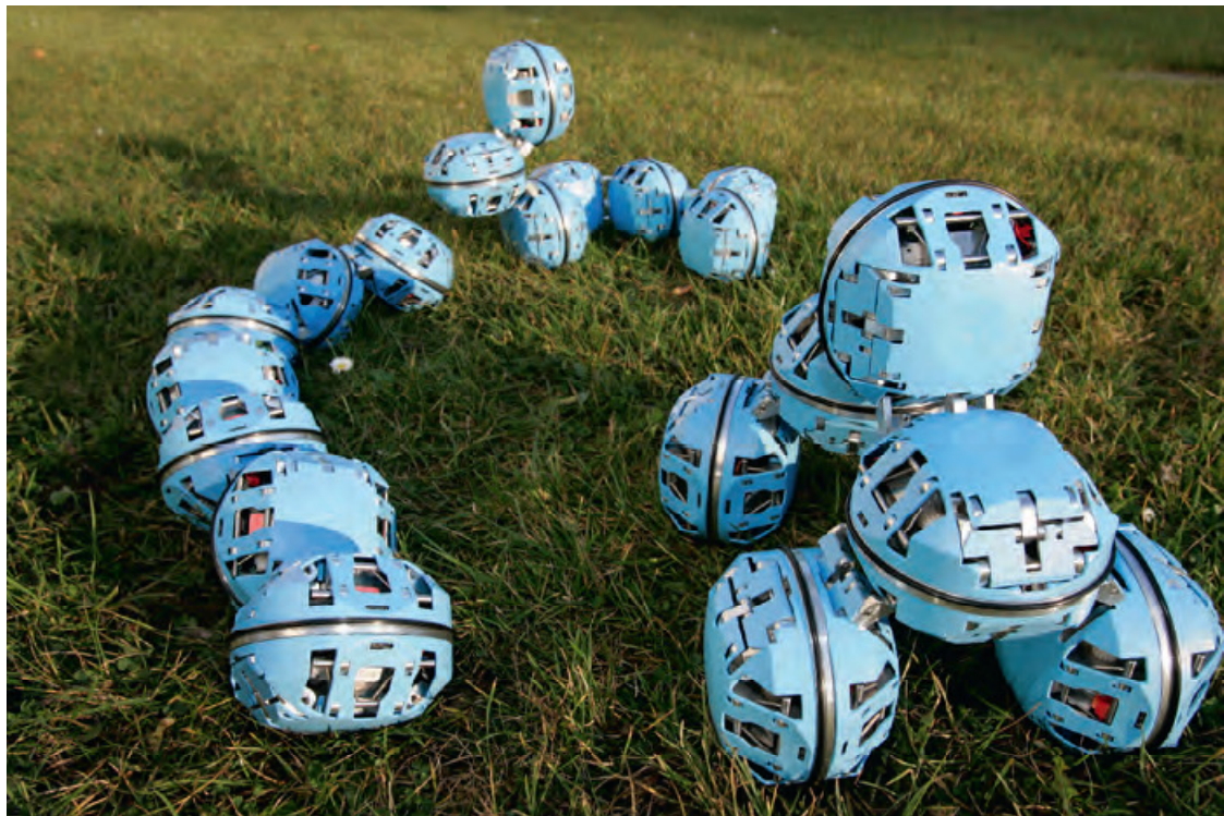
Σχήμα 1.7: Το ρομποτικό σύστημα “Atron”. Αν και ανήκει στην κατηγορία των συστημάτων τύπου πλέγματος, μπορεί να σχηματίσει και δομές τύπου αλυσίδας.
