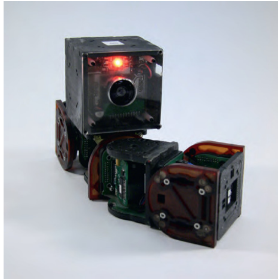
Σχήμα 1.11: Η εξέλιξη του “PolyBot”, το CKBot, στο οποίο είναι προσαρμοσμένη μία ειδική μονάδα – κάμερα.
