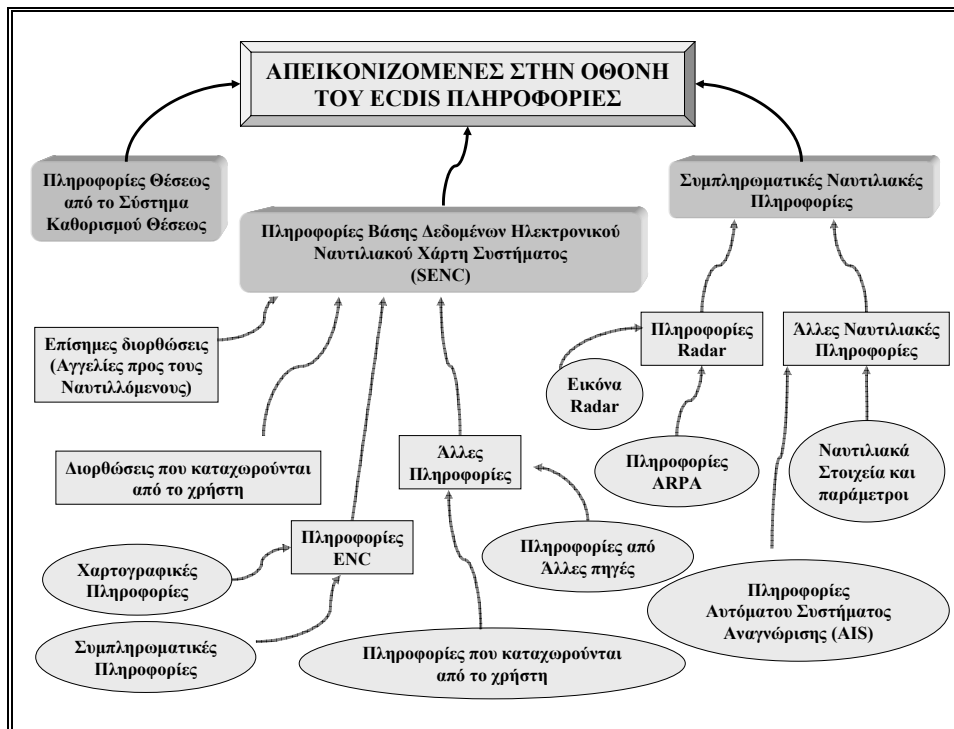
Σχ. 1.11: Απεικόνιση χαρτογραφικών και ναυτιλιακών πληροφοριών στην οθόνη ΣΗΝΧ
