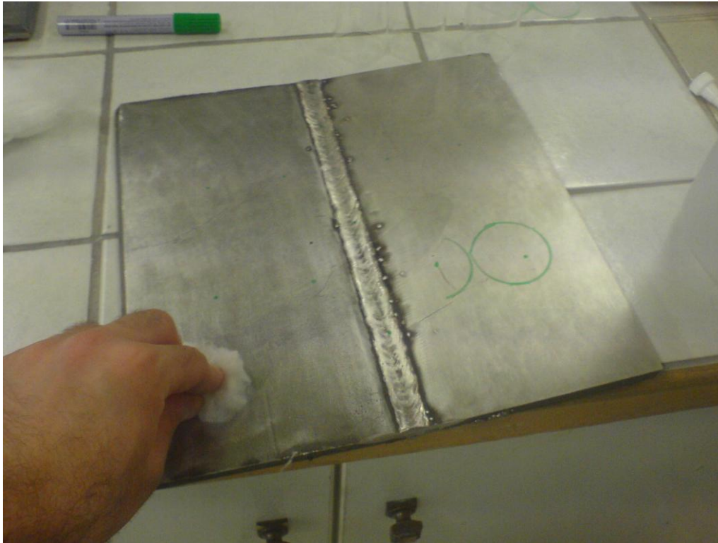
Εικόνα 7.6: Καθαρισμός ελάσματος με αιθανόλη
