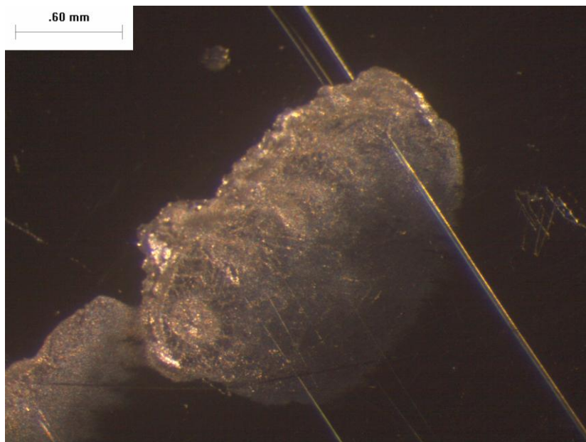
Εικόνα 8.33: Βελονισμοί στο μέταλλο βάσης 316L
