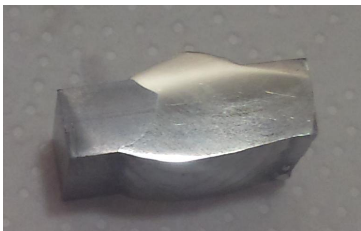
Εικόνα 8.29: Δοκίμιο ΑΗ36 για μέτρηση μικροσκληρότητας
