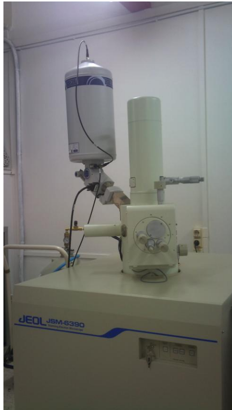
Εικόνα 7.16: Ηλεκτρονικό Μικροσκόπιο Σάρωσης τύπου JSM6390 της εταιρείας JEOL. Διακρίνονται η στήλη των ηλεκτρονίων και ο θάλαμος του δοκιμίου.
