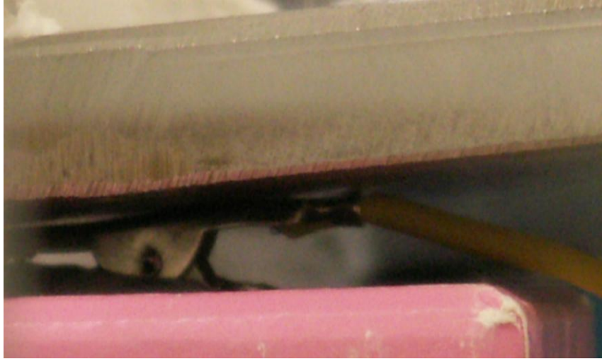
Εικόνα 7.5: Το ηλεκτρόδιο εργασίας τοποθετήθηκε στην κάτω πλευρά του ελάσματος
