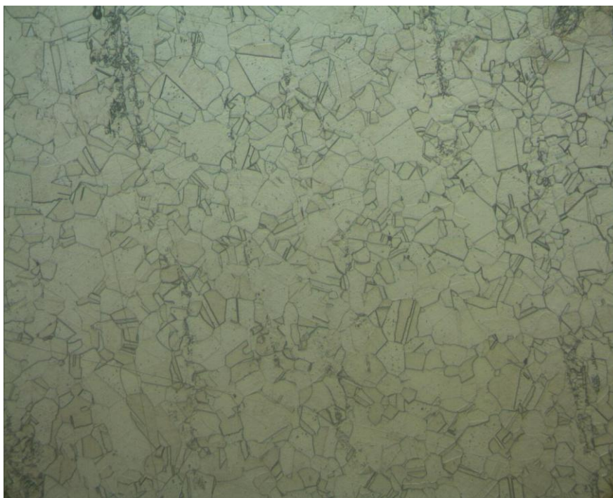
Εικόνα 8.2: Μικρογραφία μετάλλου βάσης του χάλυβα 316L (20x). Διακρίνονται οι διδυμίες στους κόκκους του ωστενίτη (Glyceregia)
