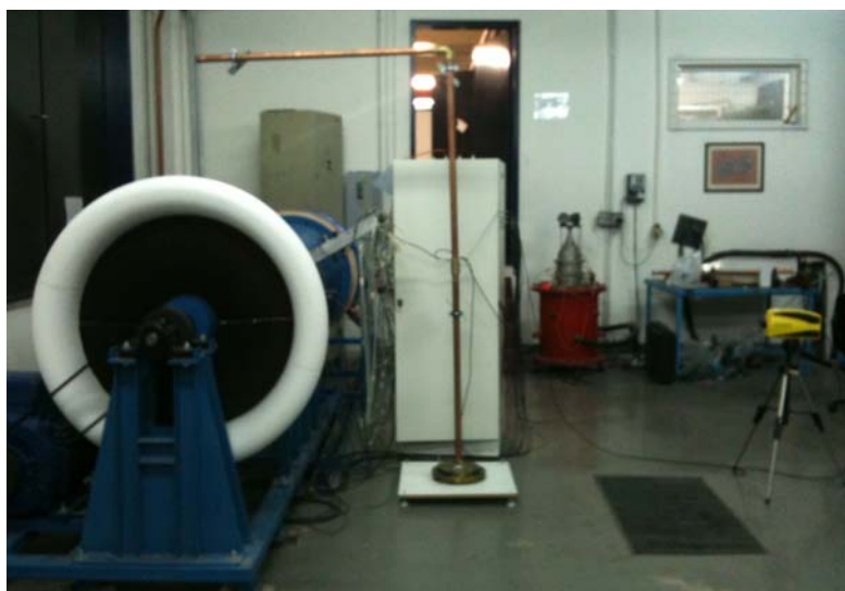
Σχήμα 4.4: Μέτρηση κατακόρυφου κραδασμού με χρήση τριών καθρεπτών.
