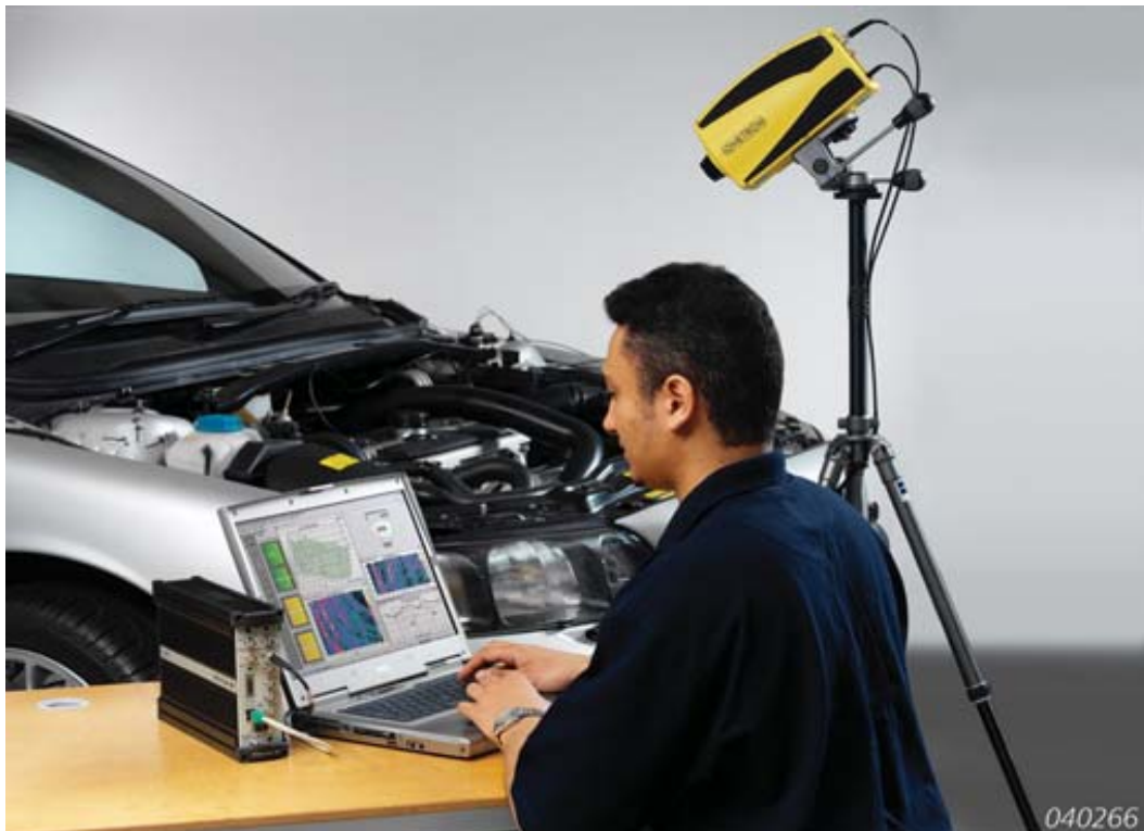
Σχήμα 2.11: Παράδειγμα μέτρησης κραδασμών σε μηχανή αυτοκινήτου.
