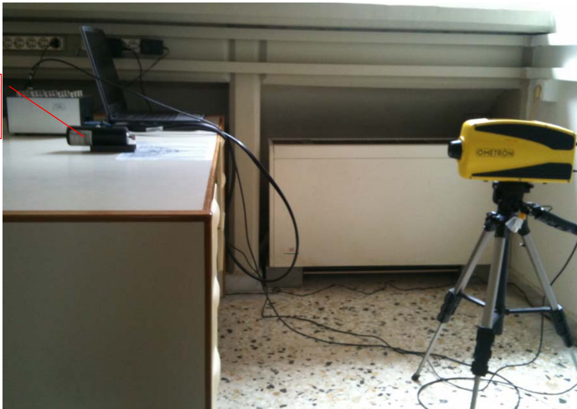
Σχήμα 3.3: Τοποθέτηση του Calibration Exciter Type 4294 και του VH-1000-D.
