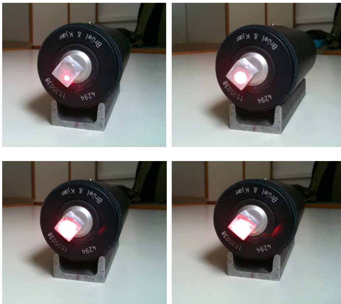
Σχήμα 3.17: (α) Πολύ καλή εστίαση, (β) Καλή εστίαση, (γ) Οριακά αποδεκτή εστίαση, (δ) Εστίαση που υπερβαίνει τα όρια του στόχου.
