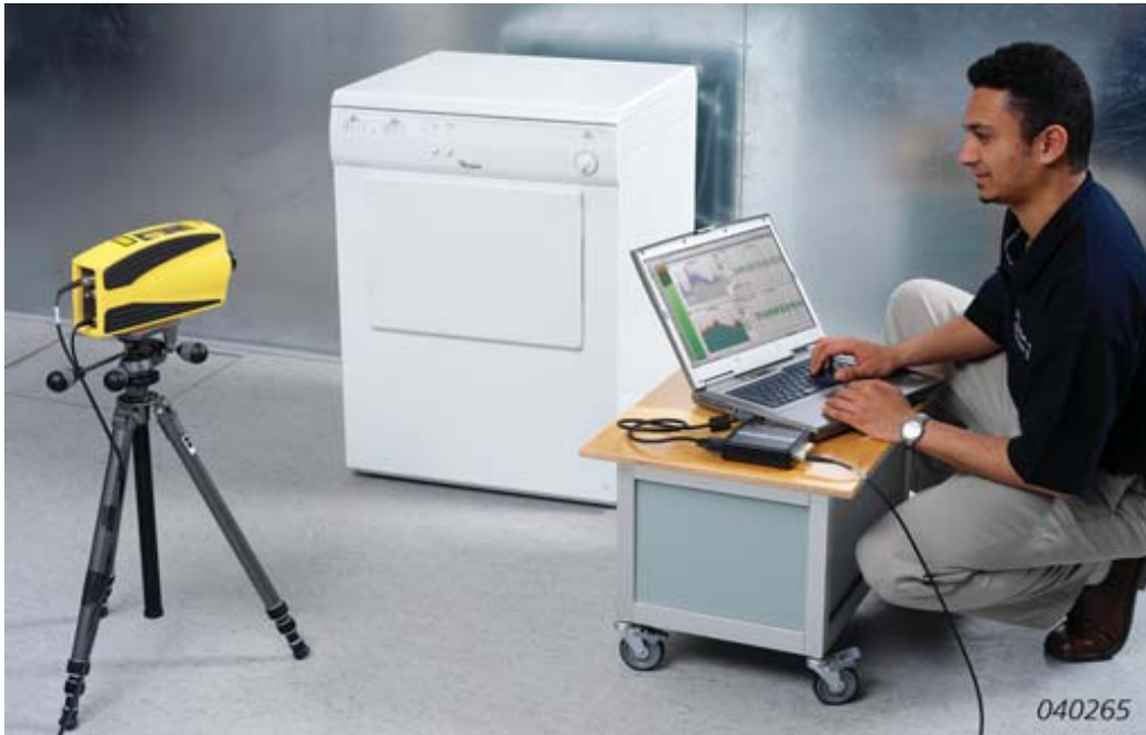
Σχήμα 2.10: Παράδειγμα μέτρησης κραδασμών σε πλυντήριο.
