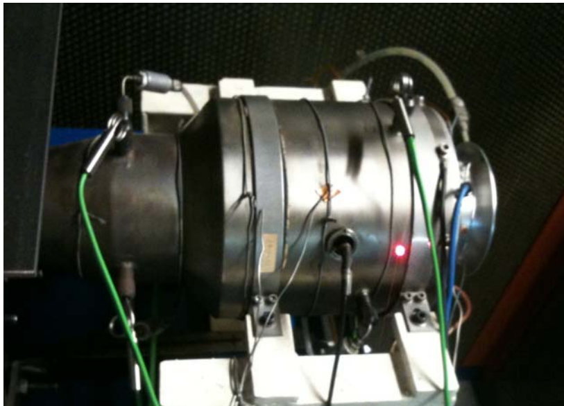
Σχήμα 4.27: Εστίαση της δέσμης του λέιζερ στη θέση του πρώτου εδράνου της μηχανής χωρίς την παρεμβολή του διπλού τζαμιού.
