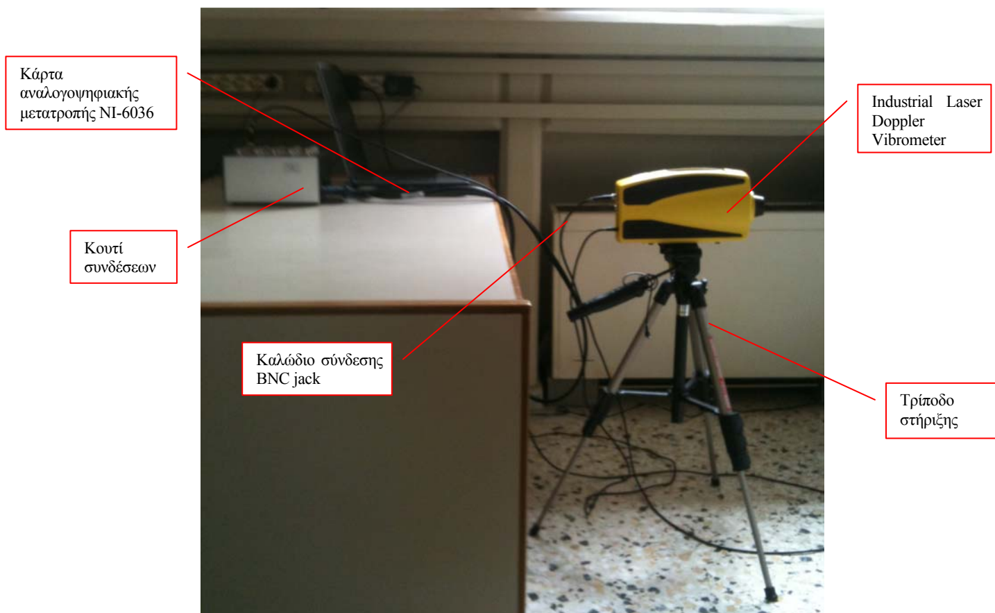
Σχήμα 2.9: Συνδεσμολογία του VH-1000-D με ηλεκτρονικό υπολογιστή.
