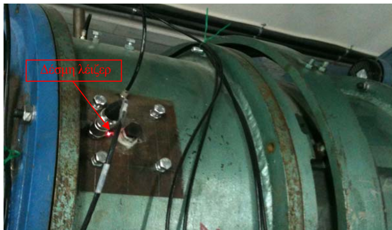
Σχήμα 4.3: Εστίαση της δέσμης του λέιζερ κατά το οριζόντιο επίπεδο δίπλα από το αντίστοιχο επιταχυνσιόμετρο.
