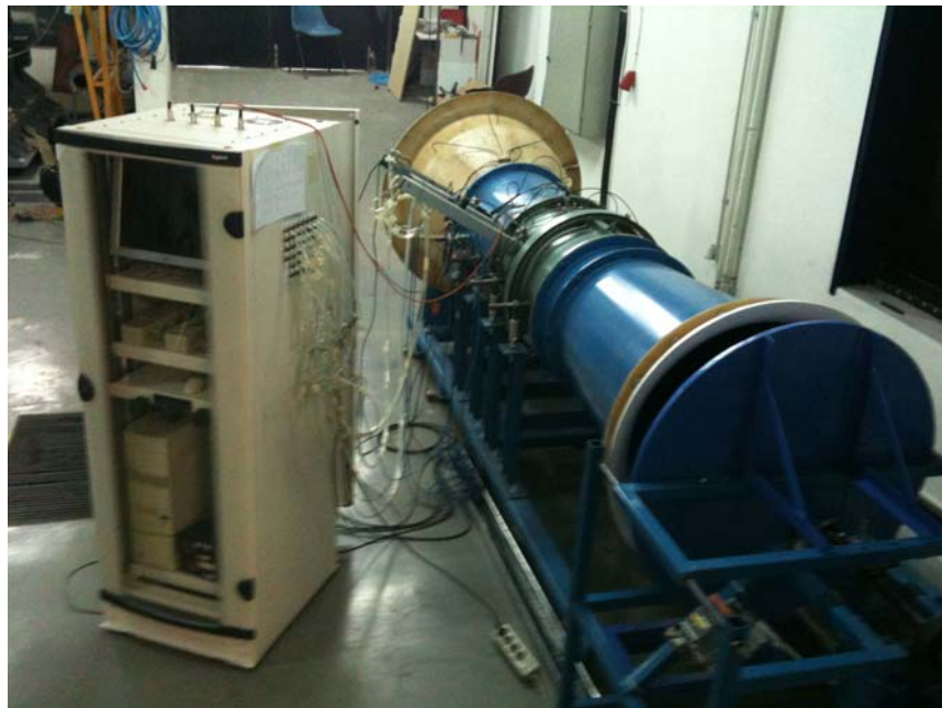
Σχήμα 4.7: Διάταξη δοκιμών αντίρροπα στρεφόμενων πτερωτών σε σύνδεση με περιβάλλον ηλεκτρονικού υπολογιστή.
