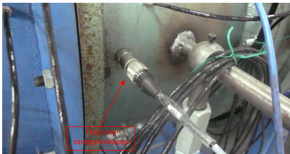
Σχήμα 4.2: Τοποθέτηση επιταχυνσιόμετρου στην ένατη ώρα της διάταξης αντίρροπα στρεφόμενων πτερωτών.
