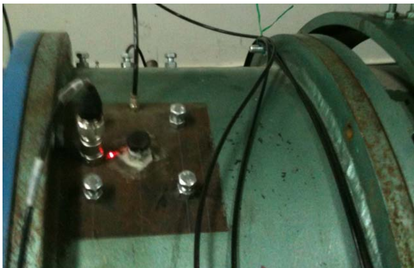
Σχήμα 4.11: Εστίαση της δέσμης του λέιζερ κατά το κατακόρυφο επίπεδο δίπλα από το αντίστοιχο επιταχυνσιόμετρο.
