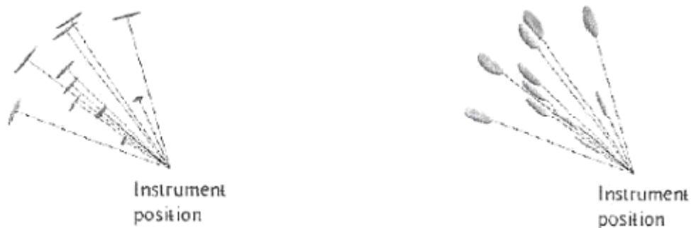
Σχήμα 1.5: (α) Ελλείψεις σφάλματος σημείων από όργανα που έχουν υψηλή ακρίβεια μέτρησης αποστάσεων σε σχέση με την ακρίβεια μέτρησης διευθύνσεων. (β) Ελλείψεις σφάλματος σημείων από όργανα που έχουν υψηλή ακρίβεια μέτρησης διευθύνσεων σε σχέση με την ακρίβεια μέτρησης αποστάσεων. [Γκουντινάκος Γ. 2004]
