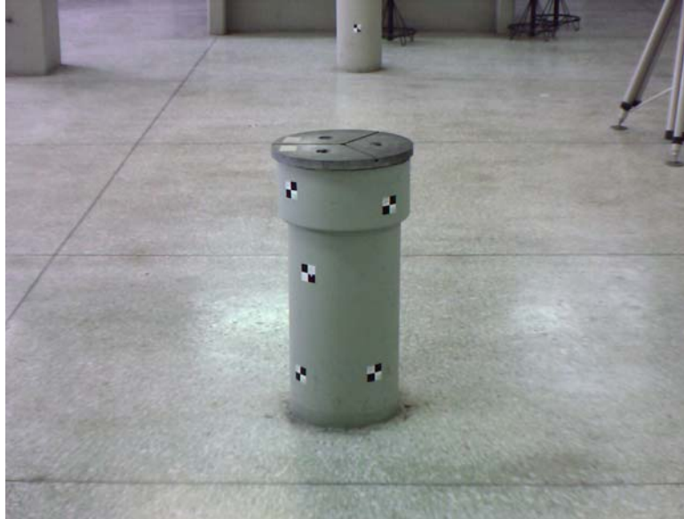
Σχήμα 4.5: Γεωδαιτικό βάρο στην αίθουσα Υ23.
