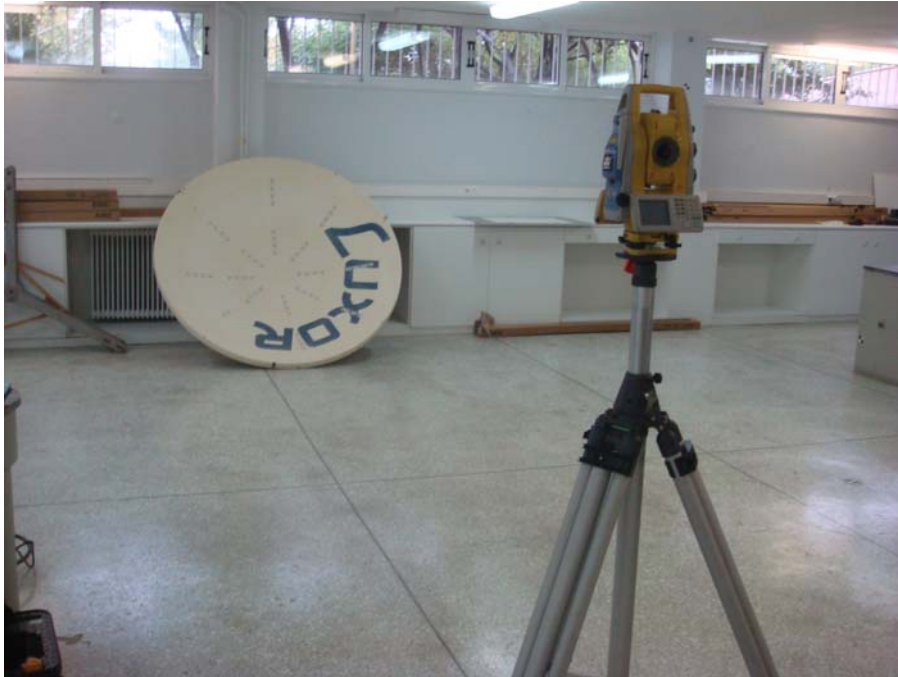
Σχήμα 4.1: Πειραματική διάταξη στην αίθουσα Υ23 κατά τη μέτρηση με το Topcon IS 203.
