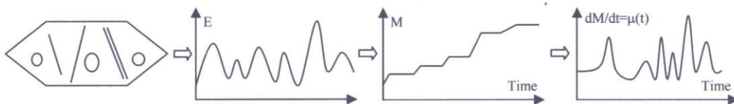
Εικόνα 9. Σχηματική αναπαράσταση των αλμάτων Barkhausen λόγω της υπερπήδησης σημείων αγκύρωσης
