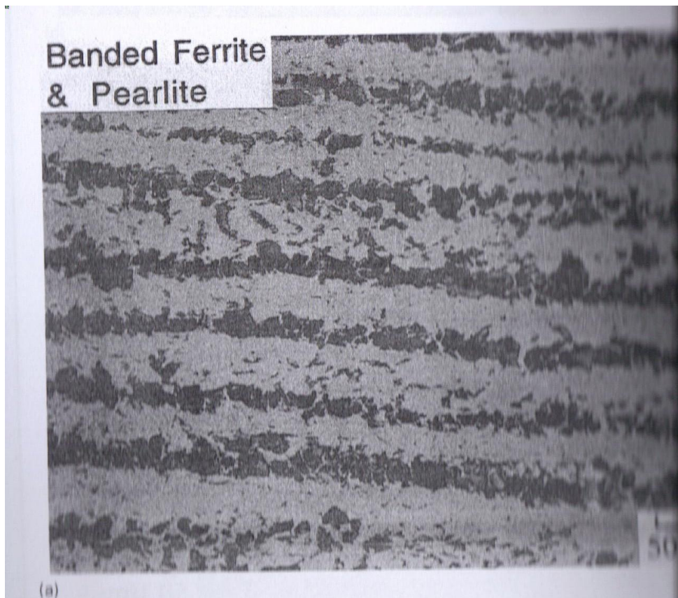
Εικόνα 20. Ζώνες φερρίτη-περλίτη, μικροδομή μακριά από τη συγκόλληση.
