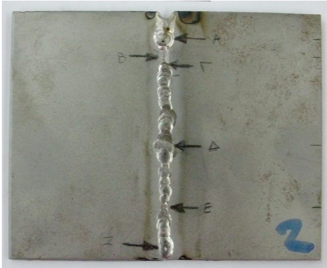
Εικόνα 30. Δοκίμιο Νο2. Συγκόλληση με ελαττώματα
