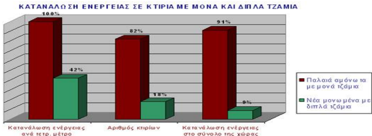
Σχήμα 6 Κατανάλωση ενέργειας σε κτίρια με μονά και διπλά τζάμια(είναι εμφανές πως τα διπλά τζάμια είναι πιο αποδοτικά σε σχέση με τα μονά)
