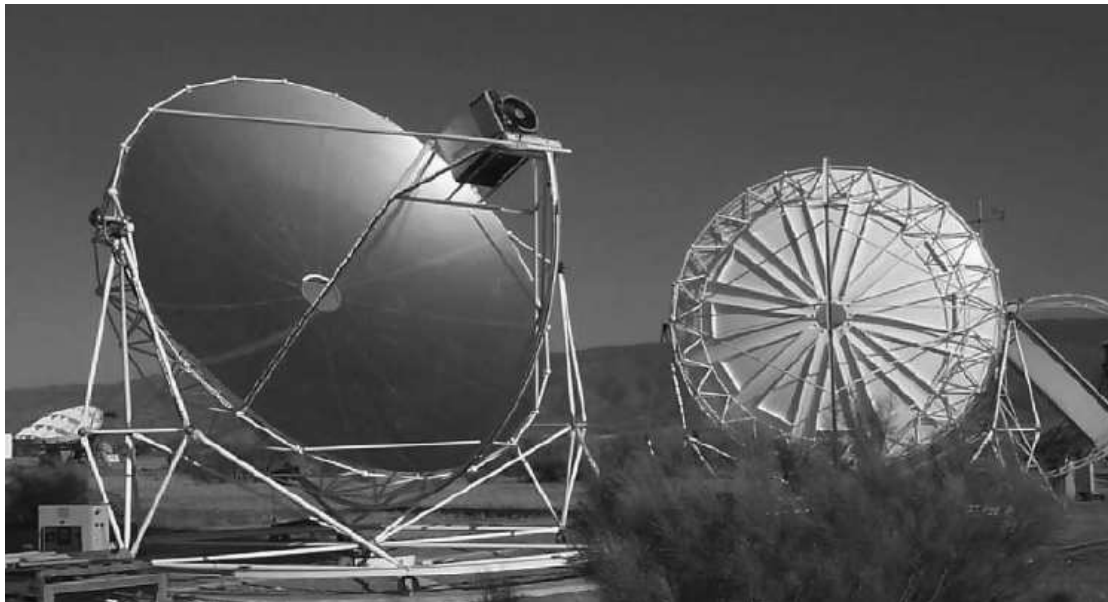
Σχήμα 4.6: Δύο μονάδες Eurodish ισχύος 10 kW e στην εγκατάσταση Plataforma Solar de Almeria στην Ισπανία.
