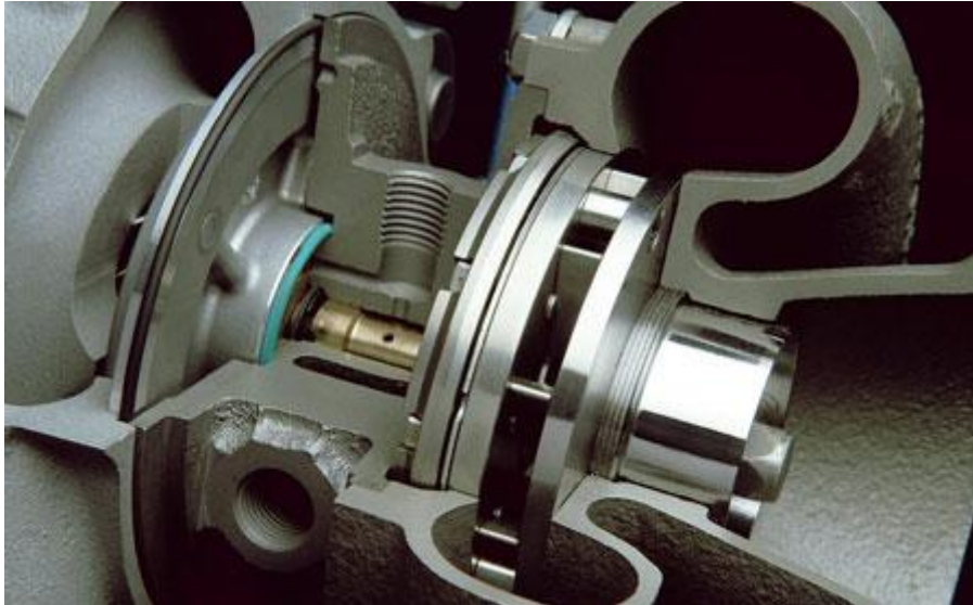
Σχήμα 3.6 : VGT πλήρως ανοικτά για υψηλές στροφές του κινητήρα
