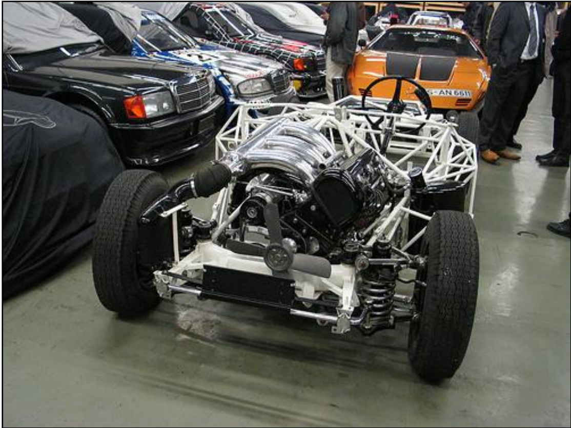
Εικόνα 17.7. Τομή του C-111.
