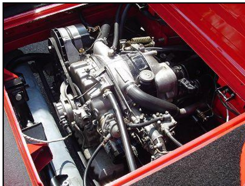
Εικόνα 1.6. Ο κινητήρας Wankel του NSU Spider Car, του πρώτου αυτοκινήτου παραγωγής με μηχανή τέτοιου τύπου.
