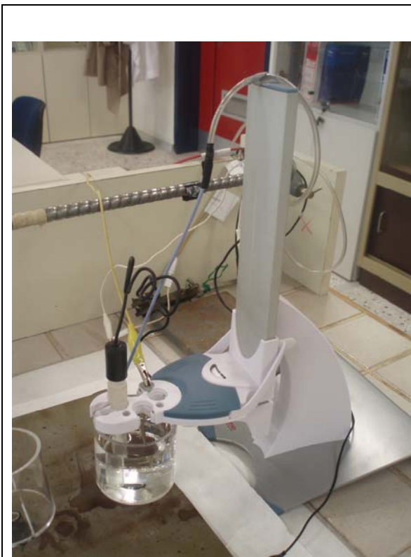
Εικ. 5.6: Πειραματική διάταξη ηλεκτροχημικών μετρήσεων στο έλασμα.
