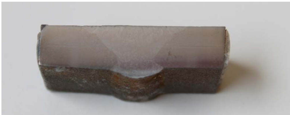
Εικ. 5.13: Λειασμένο και προσβεβλημένο δοκίμιο από την τομή της συγκόλλησης για τη δοκιμή της μικροσκληρομέτρησης.
