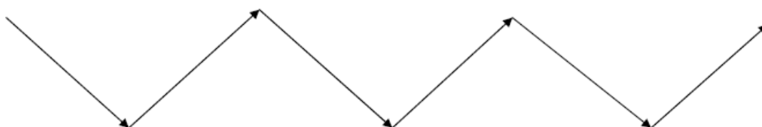
Σχήμα 3.76: Μετακίνηση του υδροπτέρου κατά το πριονωτό πρότυπο.
