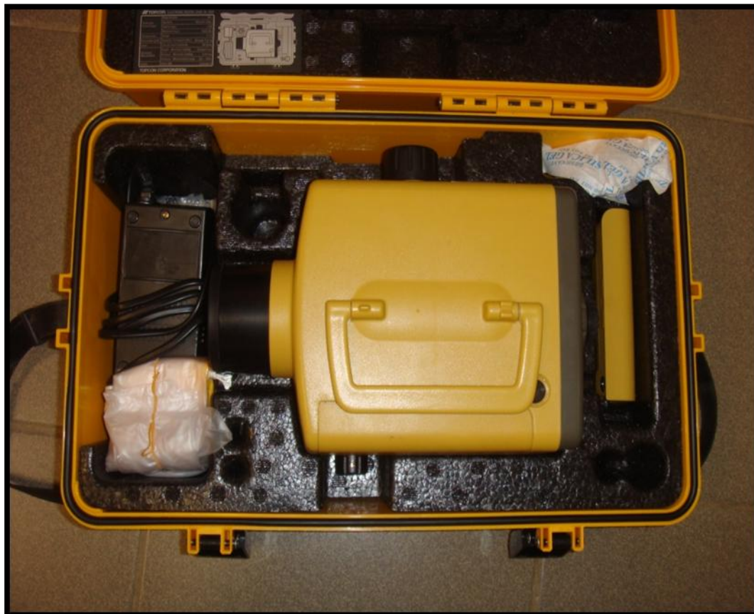
Εικόνα 5.4 Ψηφιακός χωροβάτης TOPCON DL-102C
