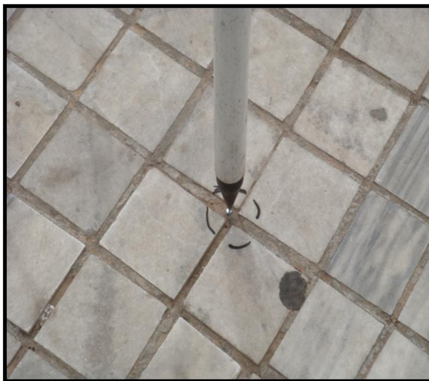
Εικόνα 5.2 Νέα υψομετρική αφετηρία
