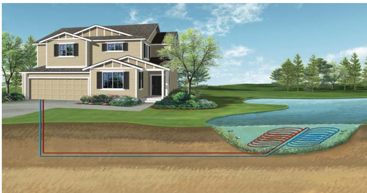
Σχήμα 4.4: Κλειστό γεωθερμικό σύστημα σπειροειδούς διάταξης [33]
