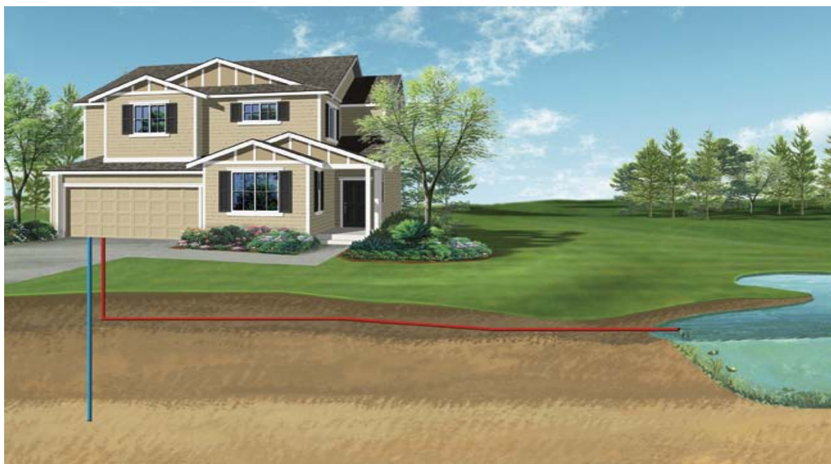
Σχήμα 4.5: Ανοικτό γεωθερμικό σύστημα [33]
