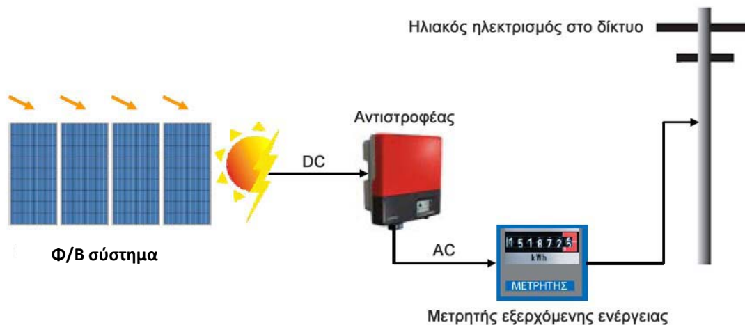
Σχήμα 2.8: Διασυνδεδεμένο Φ/Β σύστημα [23]
