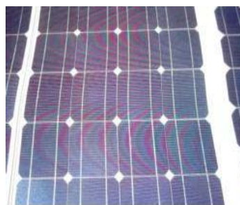
Εικόνα 2.2: Φ/Β από μονοκρυσταλλικό πυρίτιο [22]
