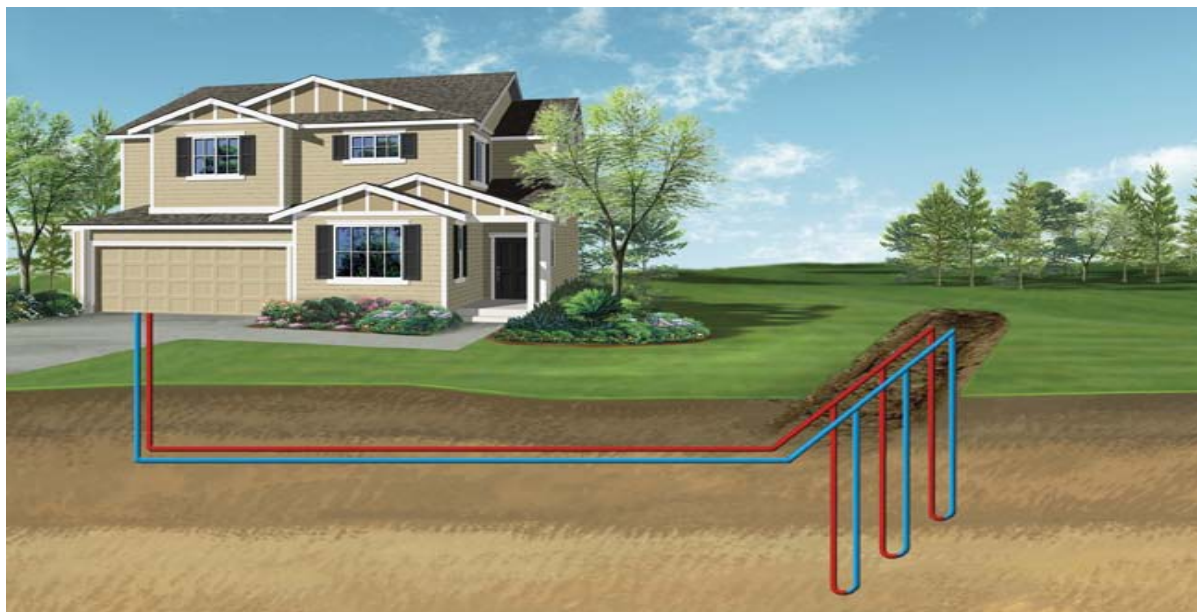
Σχήμα 4.3: Κλειστό γεωθερμικό σύστημα κάθετης διάταξης [33]
