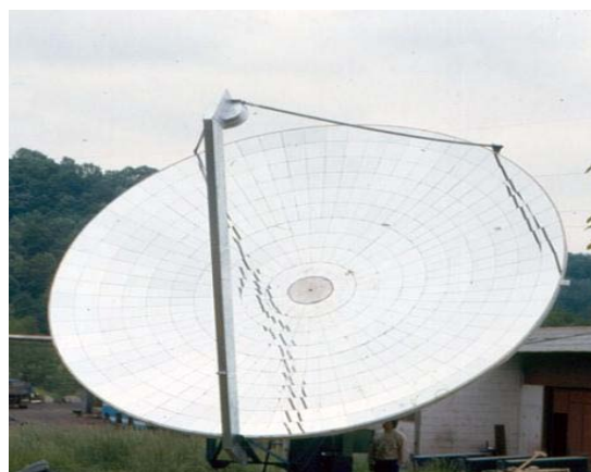
Εικόνα 3.3: Συλλέκτες γραμμικής εστίασης (αριστερά) και συλλέκτης σημειακής εστίασης (δεξιά) [13]
