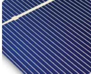
ΕΙΚΟΝΑ 25 : Κυψέλη μονοκρυσταλλικού πυριτίου [27]
