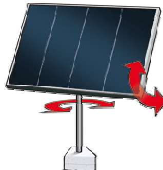
ΕΙΚΟΝΑ 36: Σύστημα παρακολούθησης της τροχιάς σε 2 άξονες ( http://www.solar-tracking.com/images/dual_axis_icon.png )
