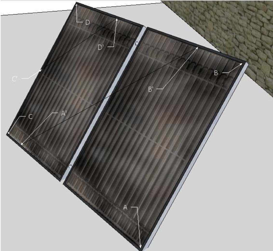
ΕΙΚΟΝΑ 9.1.3.XXXII Σκίαση ηλιακού συλλέκτη από ανατολικό και νότιο τοίχο
