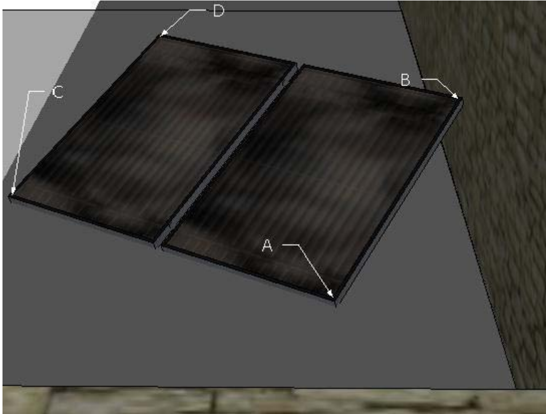
ΕΙΚΟΝΑ 9.1.3.XXXXXXIV Σκίαση ηλιακού συλλέκτη από ανατολικό και νότιο τοίχο
