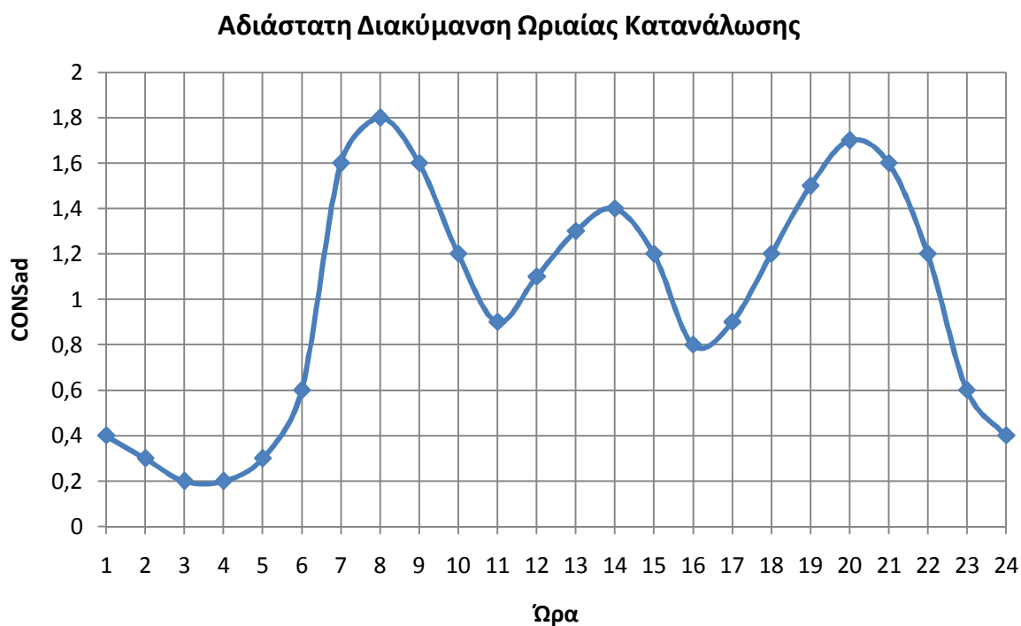
Σχήμα 6.13 Αδιάστατη διακύμανση ωριαίας κατανάλωσης νερού
