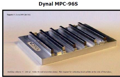
*Εικόνα 6.2 [μηχανισμοί ανάκτησης με μόνιμους μαγνήτες είτε για 96άρες πλάκες είτε για φυαλίδια]
