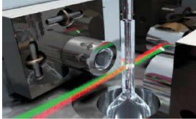
*Εικόνα 5.3 [δέσμες laser για ταυτοποίηση των σφαιριδίων]
