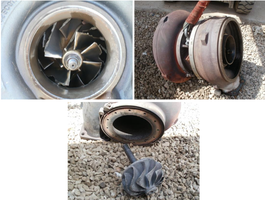
Εικόνες: Κατεστραμμένος στροβίλο-υπερπληρωτής μιας Μ.Ε.Κ.
