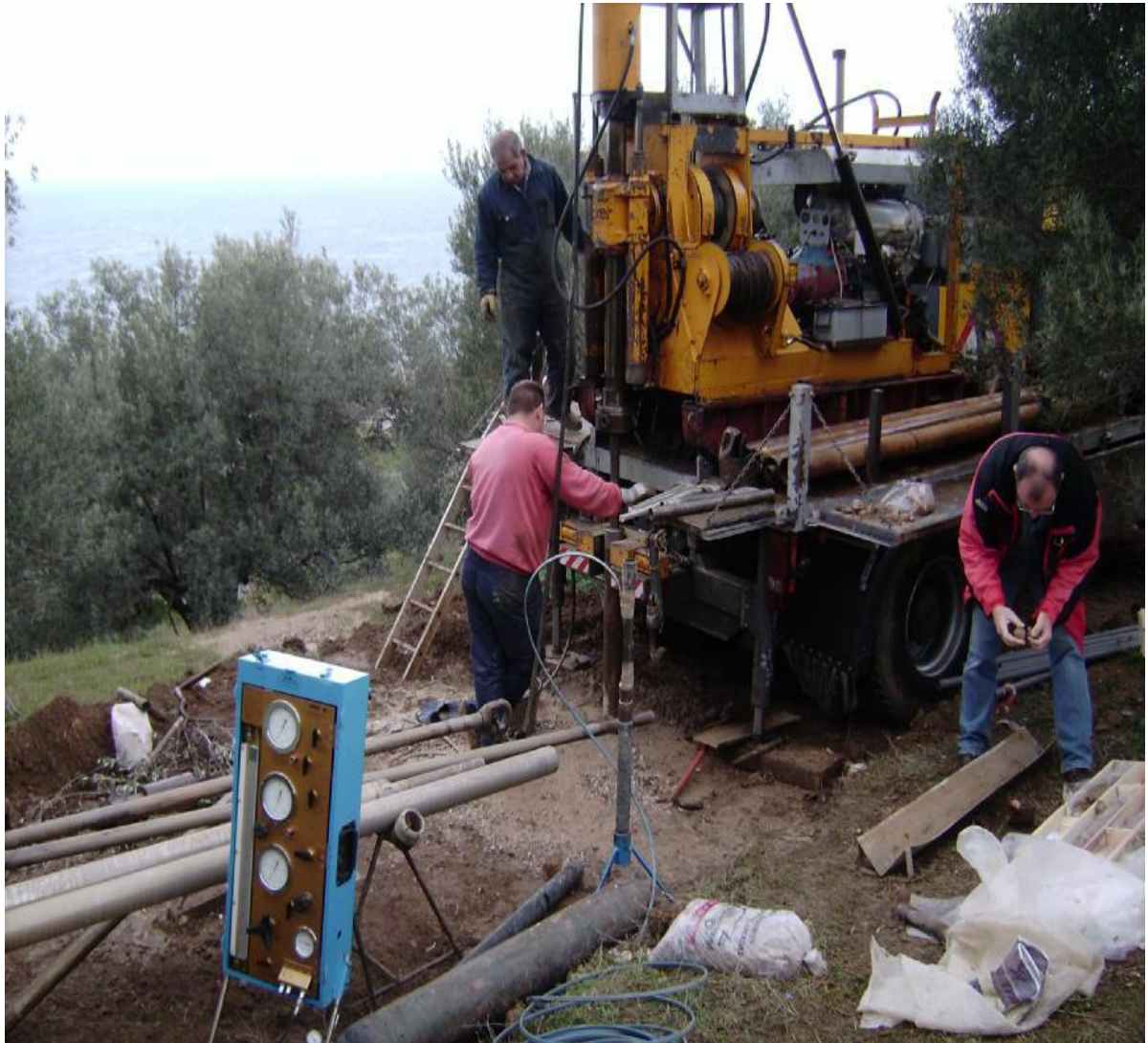
Φωτογραφία 3.1: Δοκιμές πρεσσιομέτρησης στη γεώτρηση 56ΓΝ7
