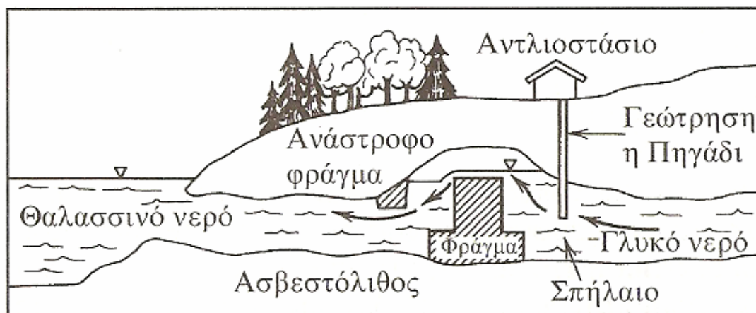
Σχήμα 5.8 Σχηματικό διάγραμμα ενός υπόγειου διαφράγματος για την παρεμπόδιση ανάμιξης γλυκού και αλμυρού νερού
