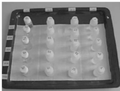
Εικόνα 11: Τεστ συμβατότητας για συνδυασμούς πλαστικών-ανόργανων PCM και πλαστικών-οργανικών PCM [28].
