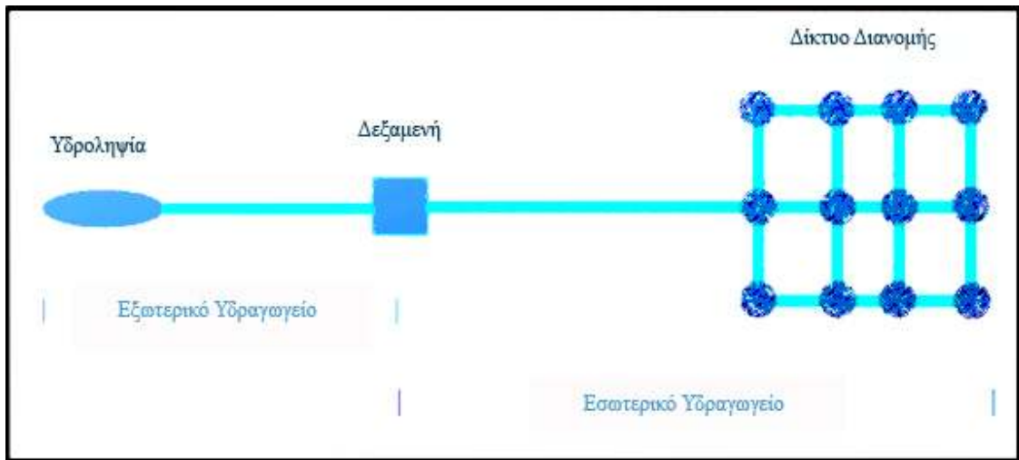
Σχήμα 1.1: Δομή δικτύων ύδρευσης
