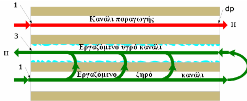
Σχήμα 2: Δισδιάστατο διάγραμμα του κύκλου του Maisotsenko
