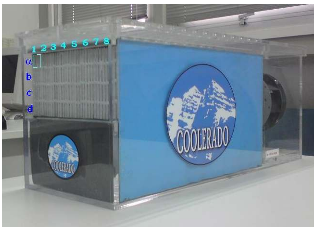
Σχήμα 3: Πλάγια πλευρά της ψυκτικής μονάδας απ' όπου εξέρχεται ο αέρας που ψύχεται
