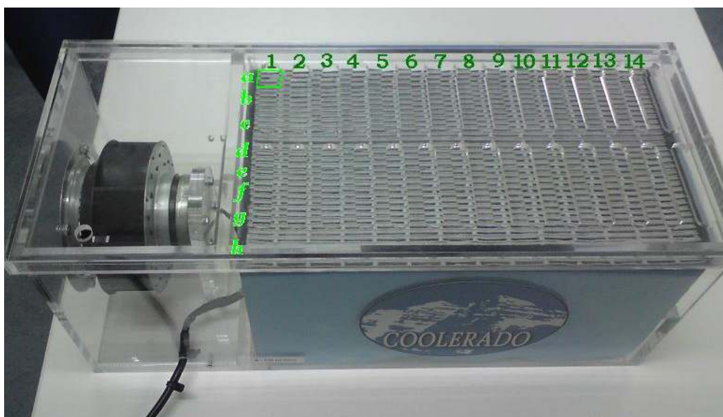
Σχήμα 2: Άνω πλευρά της ψυκτικής μονάδας απ' όπου εξέρχεται ο εργαζόμενος αέρας κορεσμένος
