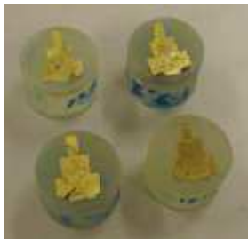
Εικ. 2.23 Εγκιβωτισμός δοκιμίων σε ρητίνη
