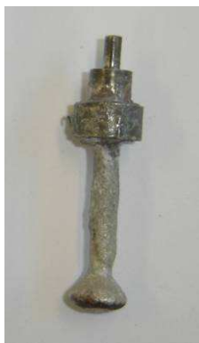
Εικ. 4.1 Χυτό δοκίμιο αλπακά, μετά από χύτευση κενού
