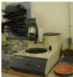
Εικ. 2.24 Το λειαντικό μηχάνημα που χρησιμοποιήθηκε
