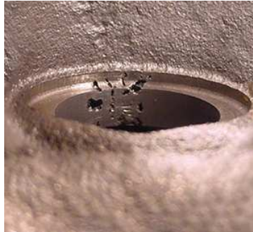
Εικ. 1.21 Εμφάνιση έντονου πορώδους στην επιφάνεια χυτού
