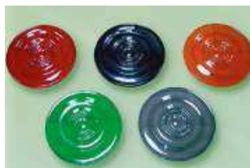
Εικ. 1.11 Ομοιώματα κατασκευασμένα με έγχυση πλαστικών
