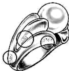
Εικ. 1.23 Αέρια εγκλείσματα στην επιφάνεια δακτυλιδιού
