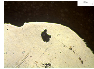
Εικ. 4.5 Μία επιφανειακή και μία εσωτερική ατέλεια στην ακμή της μεγάλης διαμέτρου του χυτού βαρύτητας.
