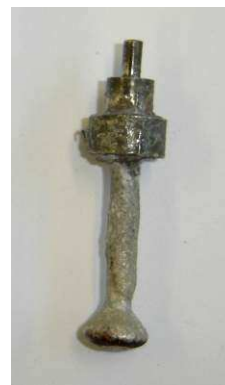
Εικ. 4.2 Χυτό δοκίμιο αλπακά, μετά από χύτευση κενού με υπερπίεση
