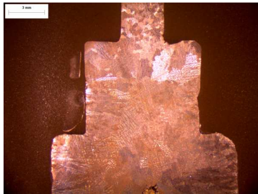
Εικ. 4.13. Χύτευση Κενού με Υπερπίεση, μεσαία διατομή.
