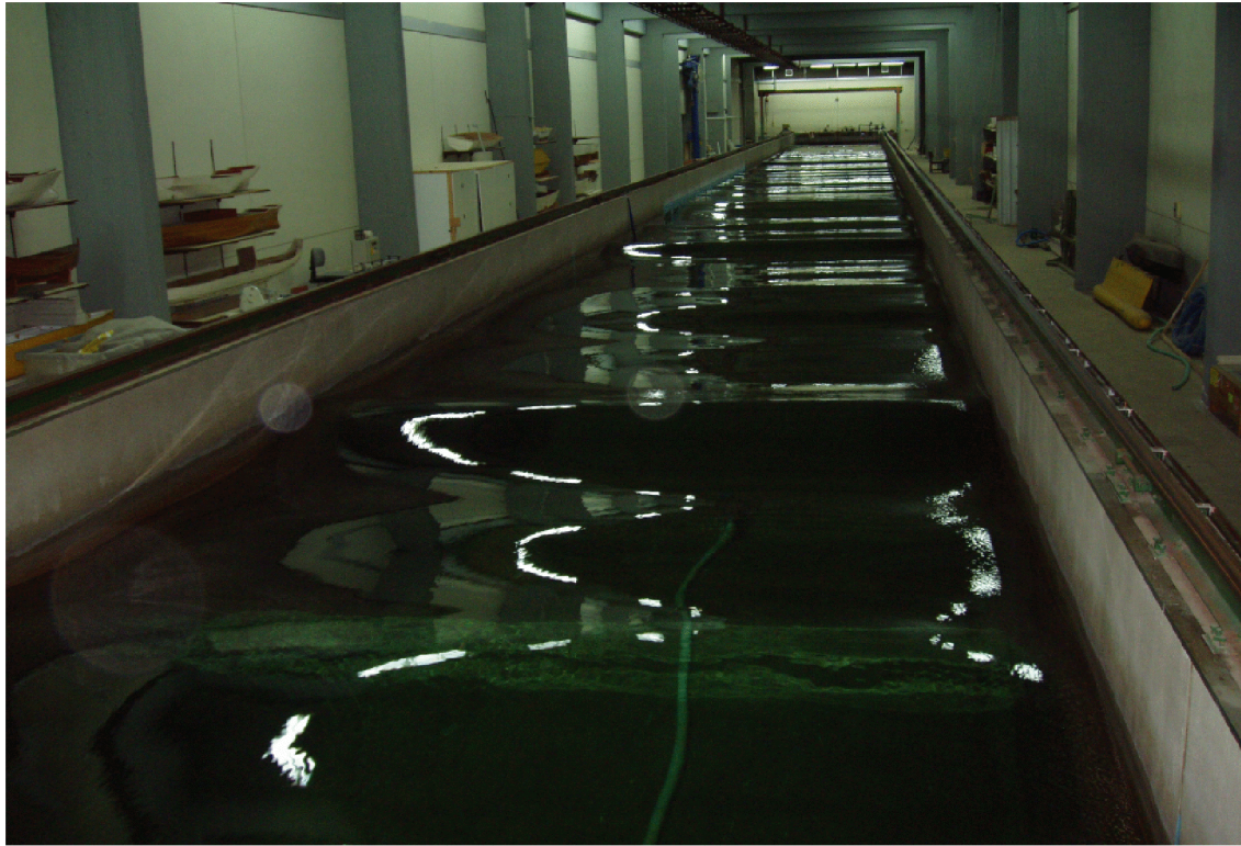
Φωτογραφία III.1: Η πειραματική δεξαμενή εν ώρα λειτουργίας του κυματιστήρα, παράγοντας κύματα με H_s=0.12 m
