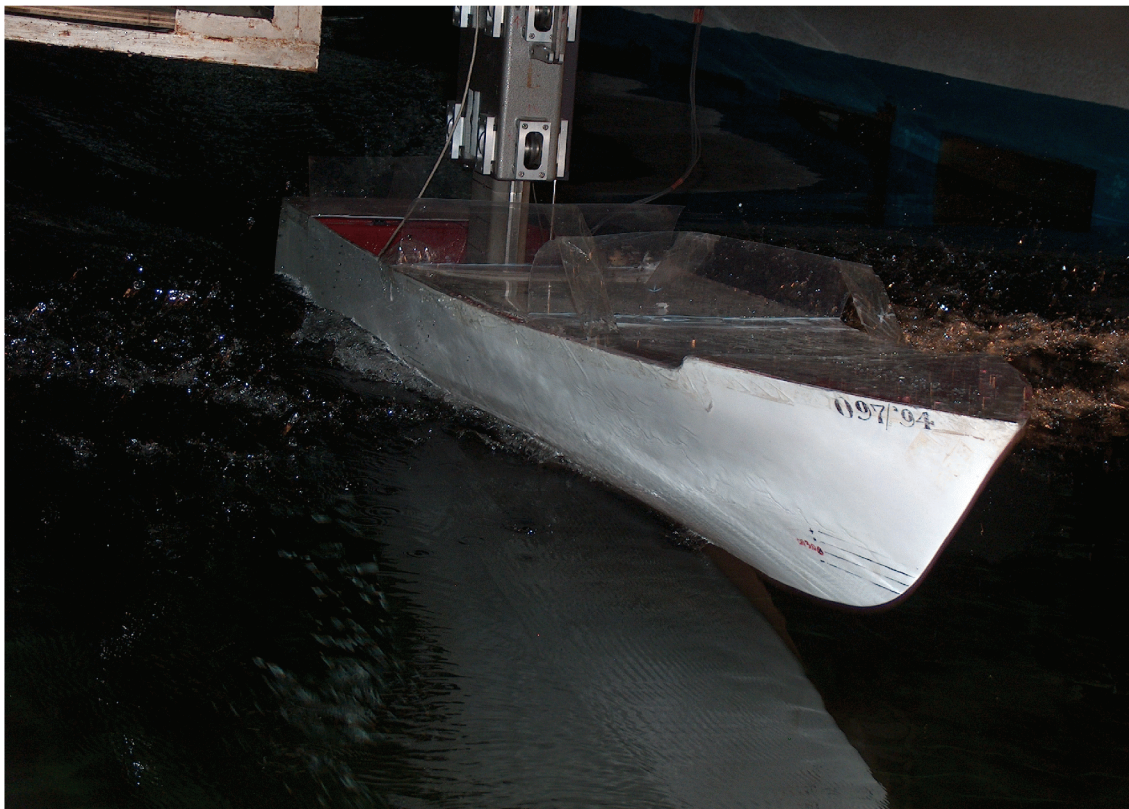
Φωτογραφία Π.4: Το πρότυπο NTUA-097/94 με L/B=5.50 κινούμενο στη μεγάλη ταχύτητα με 3,119 \text{ m/sec} σε κατάσταση θάλασσας με H_s=0.14 \text{ m}
