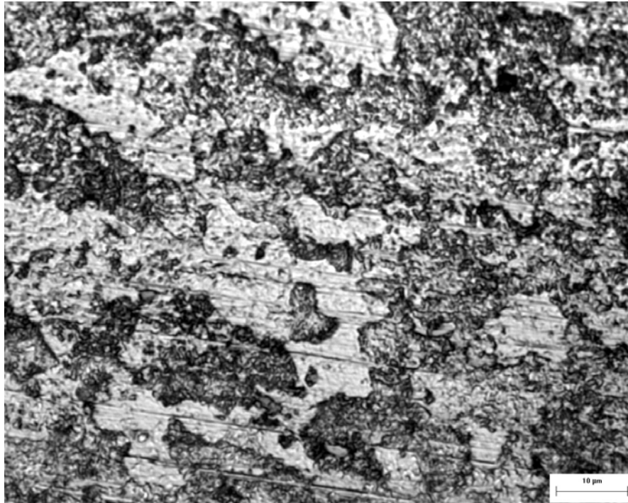
Εικόνα 6.9: Μικρογραφία του πυρήνα της συγκόλλησης (x1000).
