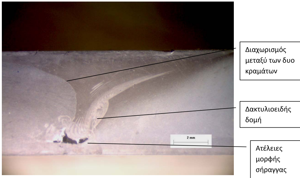
Εικόνα 6.52: Μακροσκοπική παρατήρηση της τομής του δοκιμίου.
