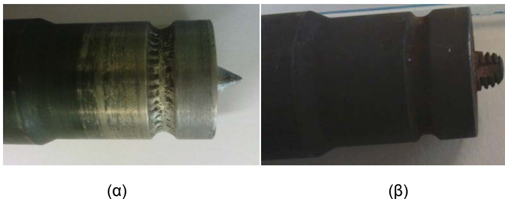
Εικόνα 5.3.1: Χρησιμοποιούμενες κεφαλές συγκόλλησης: (α) Κεφαλή επίπεδου περιαιχενίου φέρουσα κωνικό πείρο, (β) Κεφαλή επίπεδου περιαιχενίου φέρουσα πείρο με σπείρωμα και εγχοπές.
