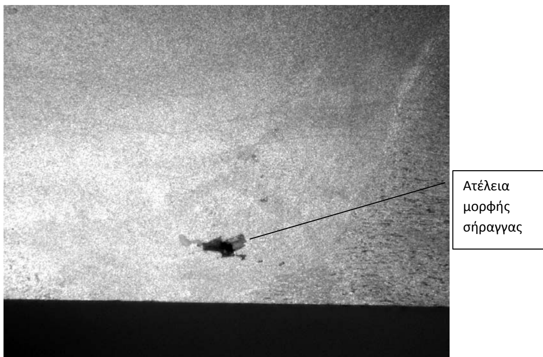
Εικόνα 6.6: Μακροσκοπική παρατήρηση της θέσης των παρατηρούμενων ατελειών.
