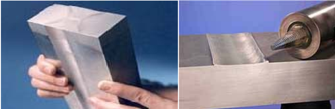
Εικόνα 2.2: Δείγματα συγκόλλησης δια τριβής μέσω ανάδευσης [5].
