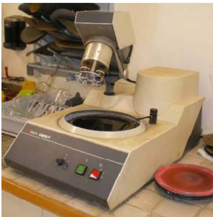
Εικόνα 5.4.2: Μηχάνημα λείανσης-στίλβωσης (Struers LaboPol-5) των δοκιμών στο Εργαστήριο Ναυπηγικής Τεχνολογίας της Σχολής Ναυπηγών Μηχανολόγων Μηχανικών.
