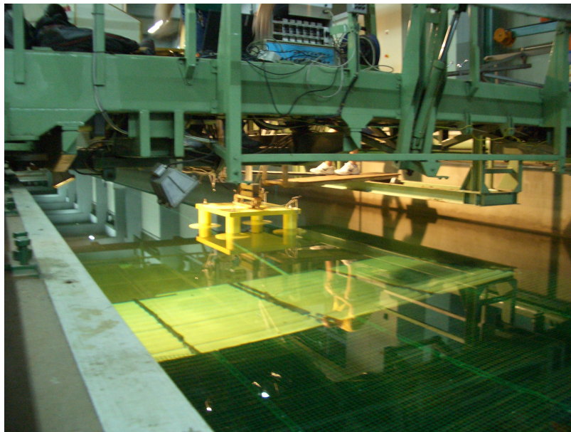
Φωτογραφία 2.4 Το πρότυπο προσαρμοσμένο στο φορείο της δεξαμενής
