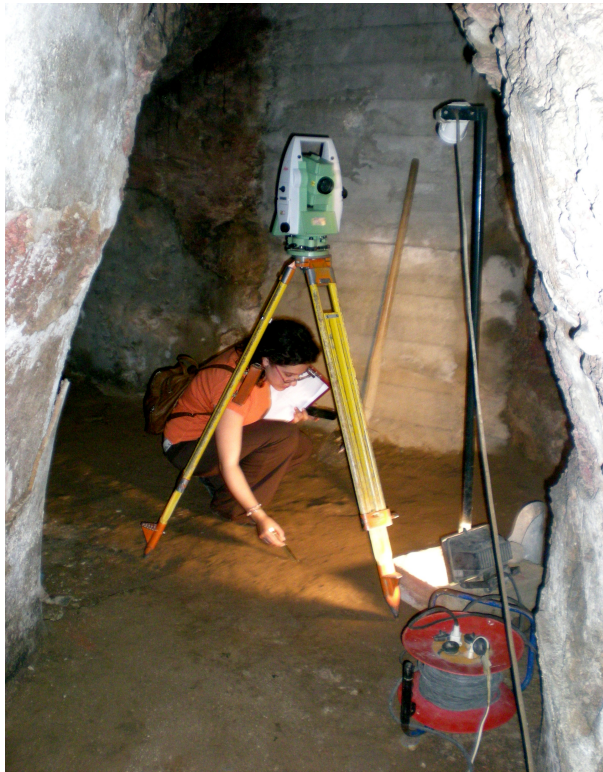
Εικόνα Π-3 Μέτρηση της στάσης Κ3 με το TCR 1202+ της Leica.
