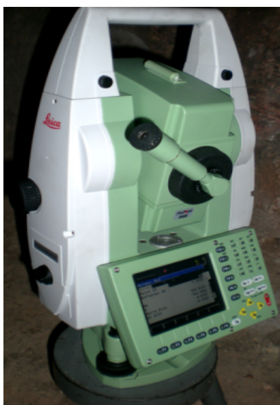
Εικόνα 3-3 Μέτρηση σημείου K2 με το TCR 1202+ της Leica (χρήση βάσης εξαναγκασμένης κέντρωσης και αγκωνοειδούς φακού).
