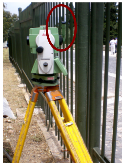
Εικόνα 3-2 Μέτρηση σημείου 019512 με το TCR 1202+ της Leica (χρήση αγκωνοειδούς φακού).
