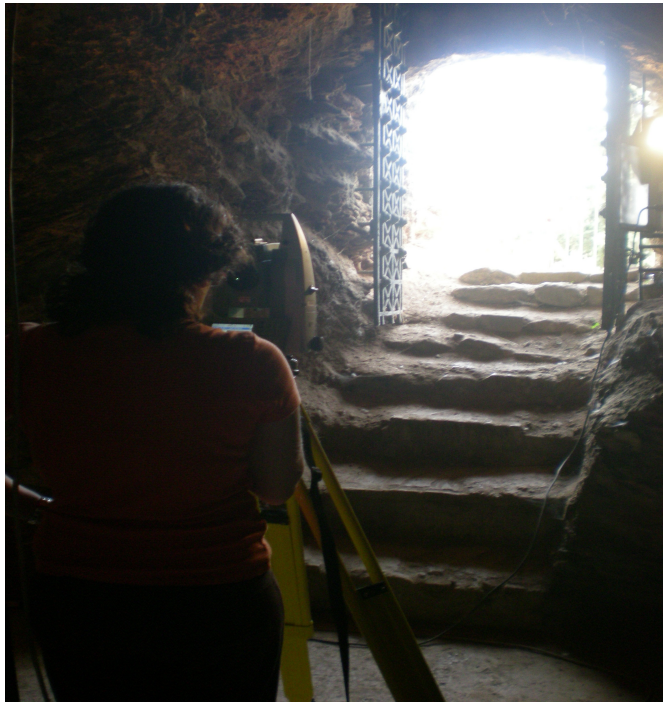
Εικόνα Π-1 Μέτρηση με total station στη στάση Κ1. Στόχευση στο τριγωνομετρικό σημείο 019512.
