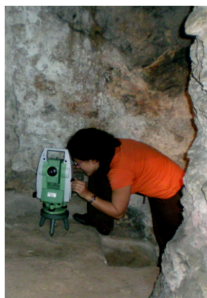
Εικόνα 3-4 Μέτρηση σημείου K2 με το TCR 1202+ της Leica (χρήση βάσης εξαναγκασμένης κέντρωσης και αγκωνοειδούς φακού).
