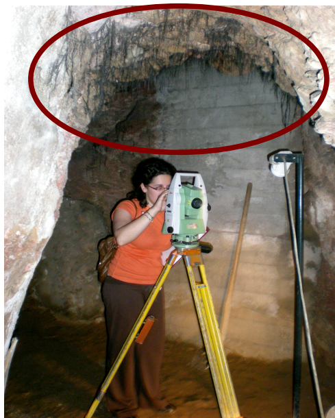
Εικόνα 6-1 Μέτρηση στη στάση K3 με total station. Απεικόνιση ριζών στα πετρώματα που αποτέλεσαν θόρυβο των μετρήσεων.
