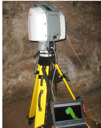
Εικόνα 5-2 Μέτρηση με το Scan Station 2, της Κ3. Παρακολούθηση της αποτύπωσης του νέφους σημείων στον Η/Υ.
