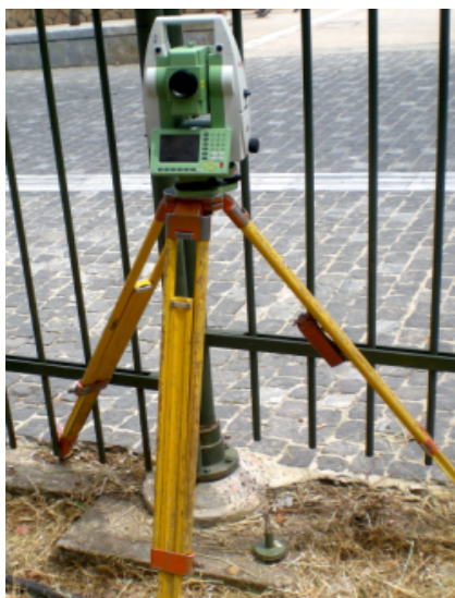
Εικόνα 3-1 Μέτρηση σημείου 019512 με το TCR 1202+ της Leica.
