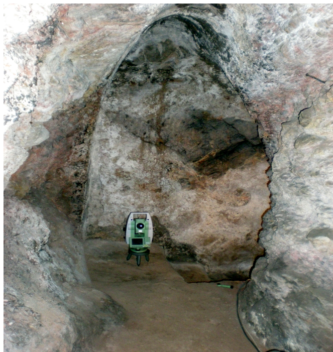
Εικόνα Π-2 Μέτρηση της στάσης Κ2 με το TCR 1202+ της Leica. Χρήση βάσης εξαναγκασμένης κέντρωσης.
