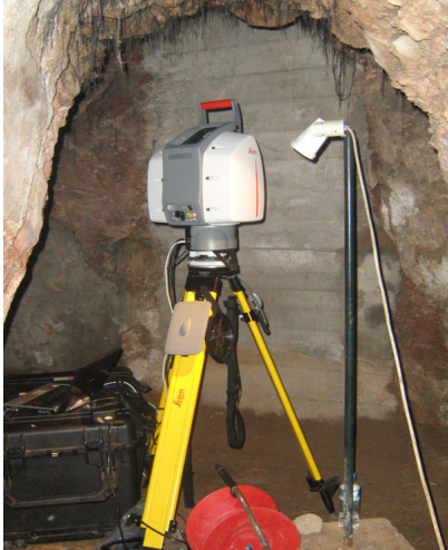
Εικόνα 5-1 Μέτρηση με το Scan Station 2, της στάσης Κ3.
