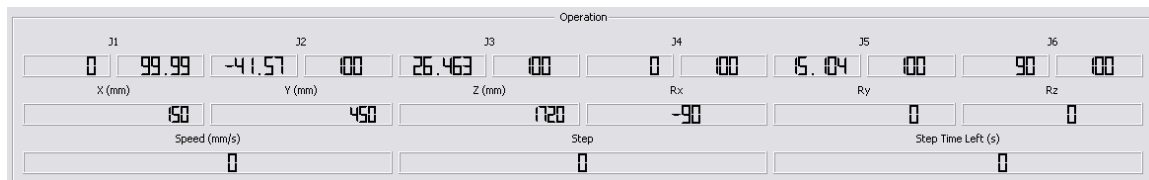
Εικόνα 6-10. Οθόνες LCD δεδομένων κίνησης / θέσης βραχίονα ( operation )
