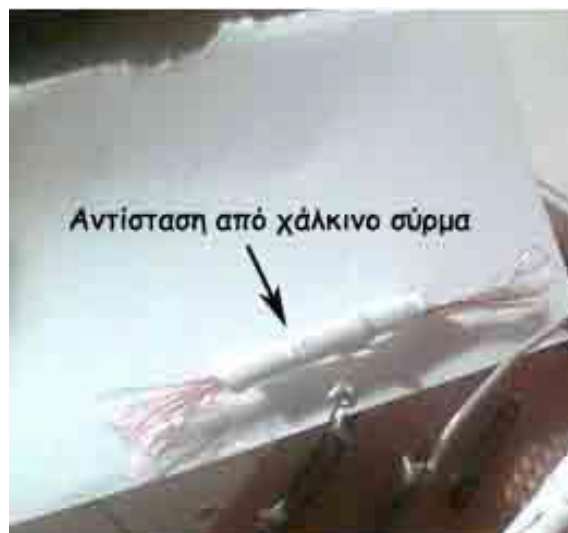
Εικόνα 57: Αντίσταση 5.2Ω κατασκευασμένη με χάλκινο σύρμα
