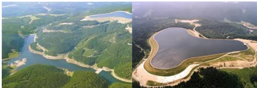
Σχήμα 2.9. Αναστρέψιμο υδροηλεκτρικό έργο στο Goldisthal της Γερμανίας με υψομετρική διαφορά 302 m, 4 αναστρέψιμες μονάδες συνολικής ονομαστικής ισχύος 1,06 GW και χωρητικότητα άνω ταμιευτήρα 700.000 m 3 [22].
