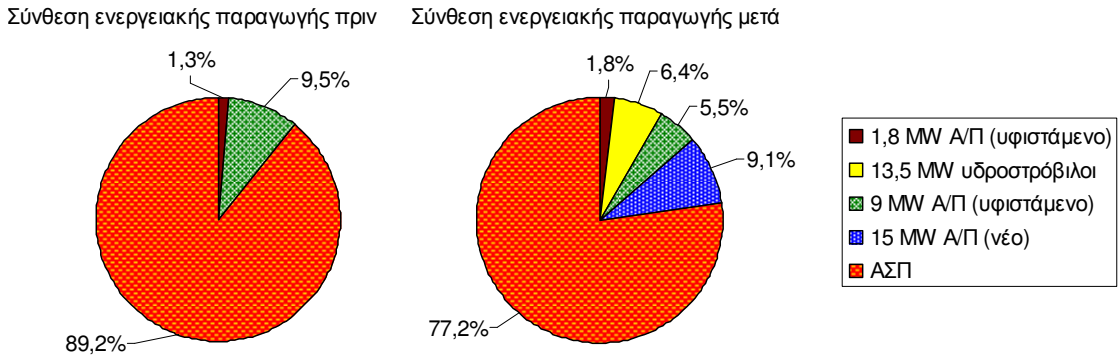
Σχήμα 7.4. Σύνθεση παραγωγής στο νησί της Λέσβου πριν και μετά την εγκατάσταση της προτεινόμενης λύσης.
