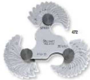
Εικ. 2.29 ελεγκτήρες (α) πάχους (β) καμπυλότητας και (γ) σπειρώματος κοχλιών
