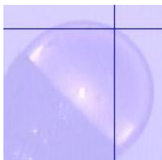
Εικ.14 Πρότυπη Σφαίρα d=0,300 mm κατά την διάρκεια μέτρησης
