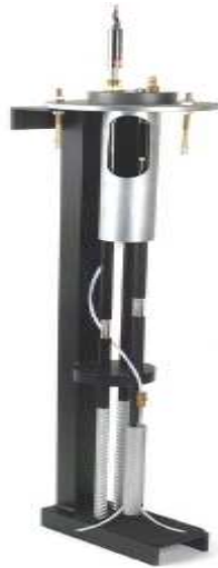
Εικόνα 21: Εκτασίμετρο Ράβδου ITM SOIL
