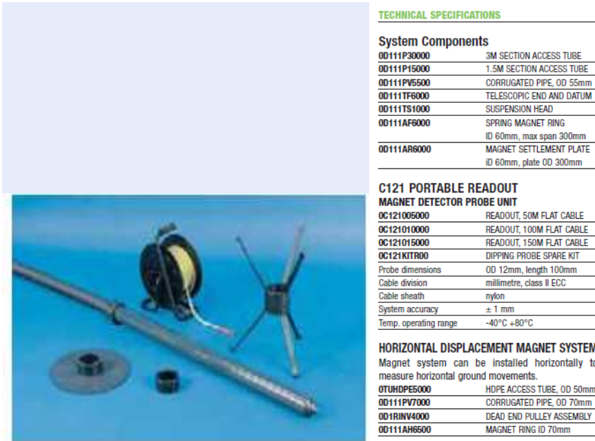
Εικόνα 18: τεχνικές προδιαγραφές μαγνητικού επιμηκυσσιόμετρου SISGEO
