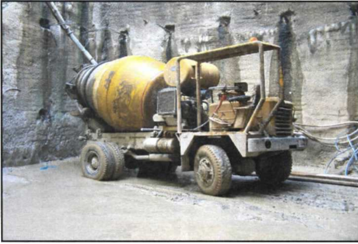
Εικόνα 13: Αυτοκινούμενος μηχανικός αναδευτήρας (βαρέλα)
