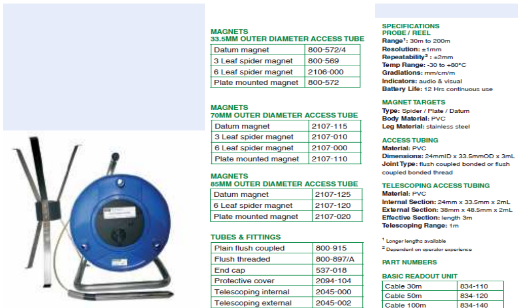
Εικόνα 19: τεχνικές προδιαγραφές μαγνητικού επιμηκυσσιόμετρου BOART LONGYEAR INTERFELS.
