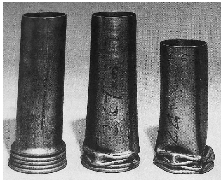
Σχήμα 2.6: Μικτή παραμόρφωση λόγω δυναμικής φόρτισης με πίπτουσα μάζα
