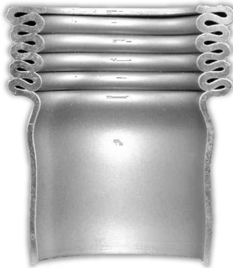
Σχήμα 2.4: Αξονοσυμμετρική συμπίεση λεπτότοιχου κυλινδρικού σωλήνα
