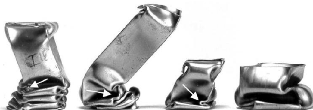
Σχήμα 2.13: Ακανόνιστη παραμόρφωση τετραγωνικών δοκιμίων
