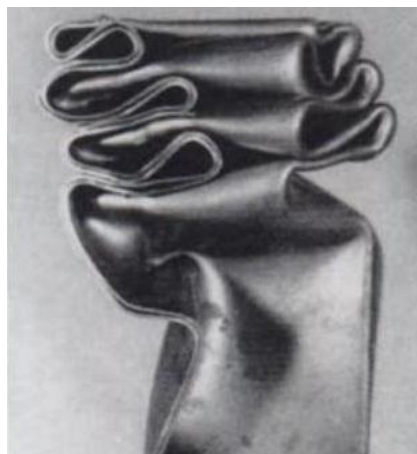
Σχήμα 2.17: Ακανόνιστη σταδιακή κατάρρευση top-hat διατομής
