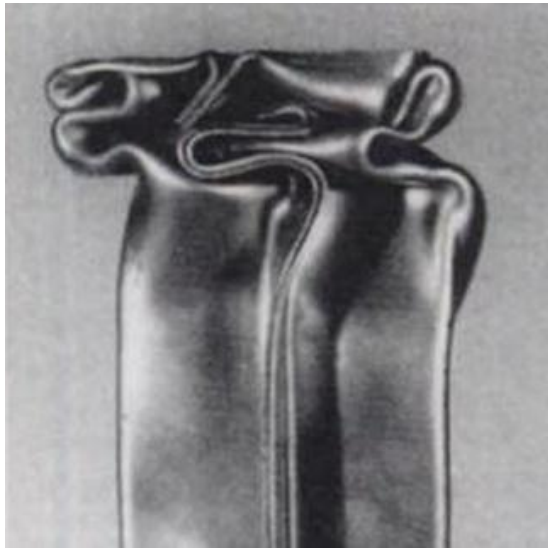
Σχήμα 2.18: Μορφή κατάρρευσης τύπου I double-hat διατομής
