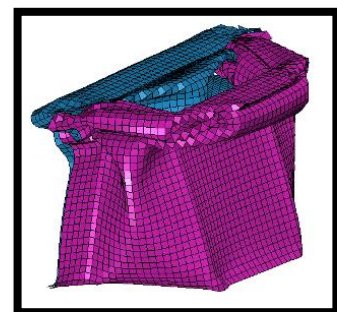
Σχήμα 7.24: Διαδικασία παραμόρφωσης με βήμα 5 mm
