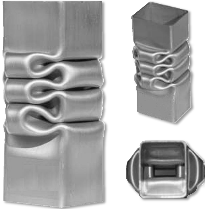
Σχήμα 2.8: Αξονική συμπίεση λεπτότοιχου τετραγωνικού σωλήνα
