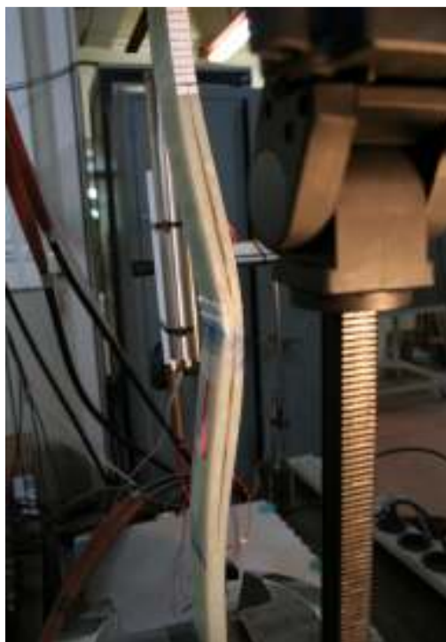
Σχήμα 4.31: Δοκίμα σειράς A-300 μετά το πέρας της πειραματικής διαδικασίας.
