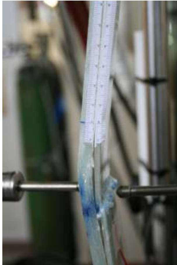
Σχήμα 4.37: Μορφή θραύσης δοκιμίου σειράς B-100 μετά το πέρας της πειραματικής διαδικασίας.
