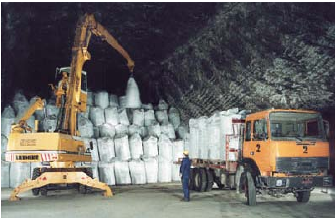
Εικόνα 1.8. Μεταφορά και απόθεση αποβλήτων στους θαλάμους.
