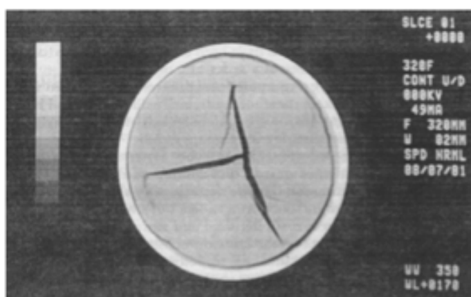
Εικ 26: Δείγμα τομογραφίας μεταλλικού υλικού με σοβαρή ρωγή στο εσωτερικό
