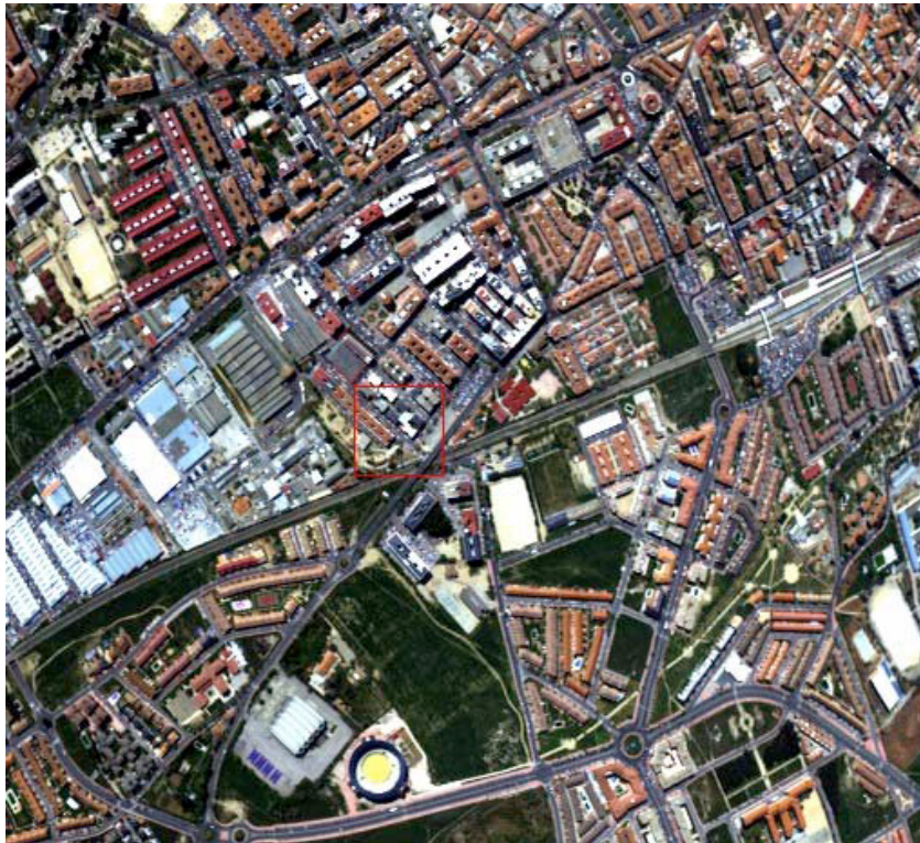
Εικόνα 1-6: Έγχρωμο σύνθετο(true color) από περιοχή της Ισπανίας. Η λήψη έγινε από τον αισθητήρα AHS(Airborne Hyperspectral Sensor).
