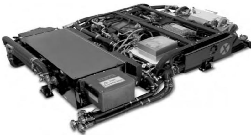
Σχήμα 2.32: Ένα σύστημα κελιών καυσίμου 75kW για ένα πρότυπο αυτοκίνητο (Mercedes Benz A-class) [12]
