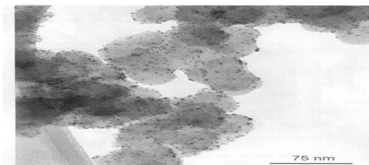
Σχήμα 2.22: Φωτογραφία (μέσω ηλεκτρονικού μικροσκοπίου) καταλυτικής επιφάνειας ηλεκτροδίων [12]
