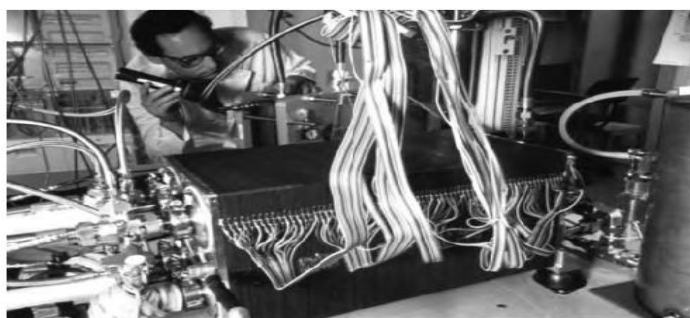
Σχήμα 2.20: Φωτογραφία μιας στοίβας κελίων καυσίμου στην διάρκεια πειράματος. Η ηλεκτρική τάση μετράται σε κάθε ένα από τα 60 κελιά ξεχωριστά [13]
