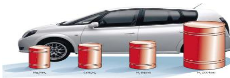
Σχήμα 3.5: Όγκος δοχείου υδρογόνου που απαιτείται για την κάλυψη της τυπικής εμβέλειας ενός επιβατικού αυτοκινήτου, αποθηκευμένου με διάφορους τρόπους
