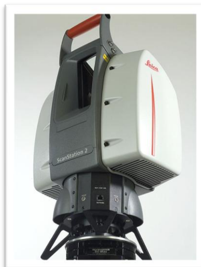
Εικόνα 3.1 : Ο σαρωτής SCANSTATION 2 της LEICA GEOSYSTEMS
