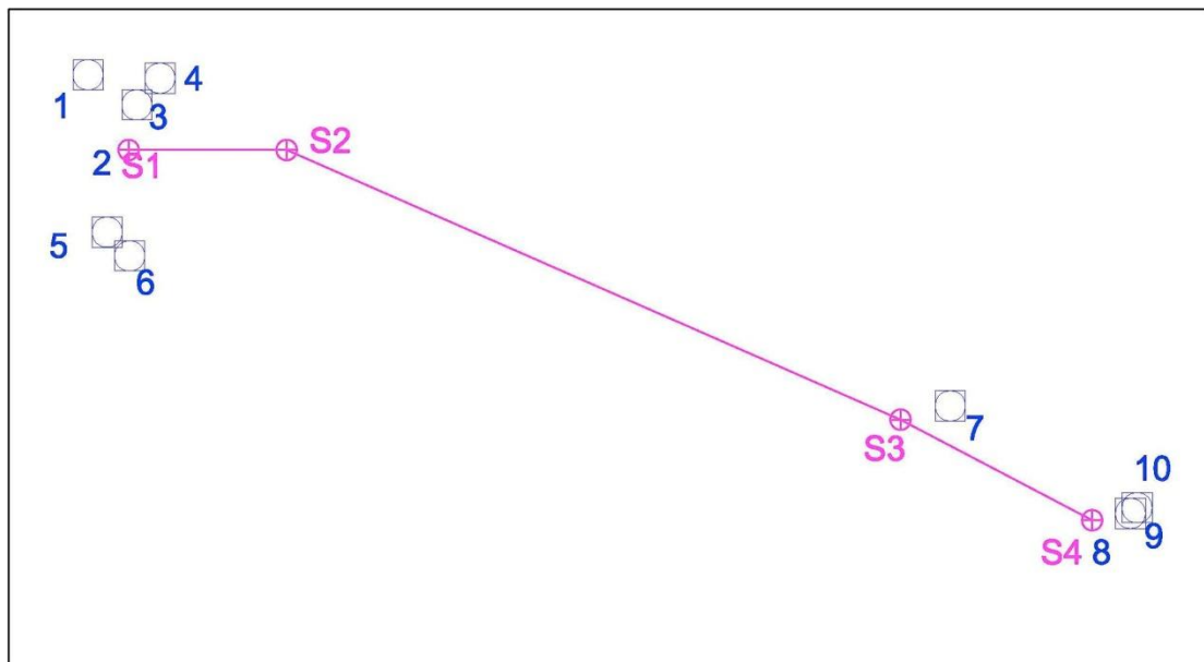
Σχήμα 5.4: Σχηματική απεικόνιση της όδευσης που υλοποιήθηκε, μαζί με το σύνολο των στόχων που χρησιμοποιήθηκαν για τη συνένωση των διαδοχικών σαρώσεων
