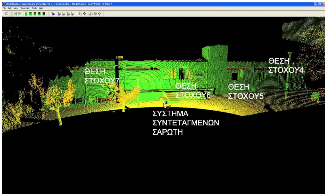
Εικόνα 4.46: Το σύστημα συντεταγμένων του σαρωτή καθώς και οι επίπεδοι στόχοι τοποθετημένοι στους τοίχους του κτιρίου από τη στάση S2.
