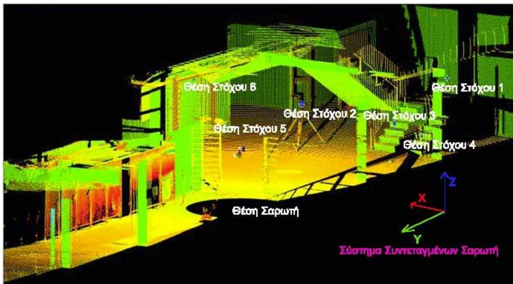
Εικόνα 4.21: Το σύστημα συντεταγμένων του σαρωτή καθώς και το πλαίσιο των στόχων που χρησιμοποιήθηκαν στη στάση S2.
