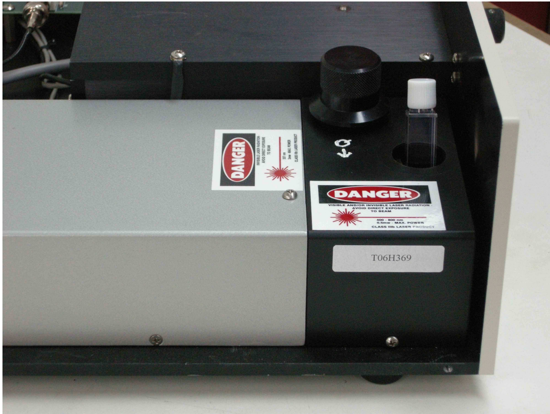
Σχήμα 3.43 - Θέση φιαλιδίου χαλαζία για το διάλυμα χρωστικής ουσίας της ΚΡΑ-11
