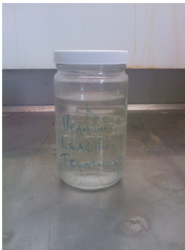
Σχήμα 4.4 - Γυάλινο δοχείο με ειδικό σφράγισμα, για τοποθέτηση φιαλιδίων τύπου LSC σε λουτρό νιτρικού οξέως.
