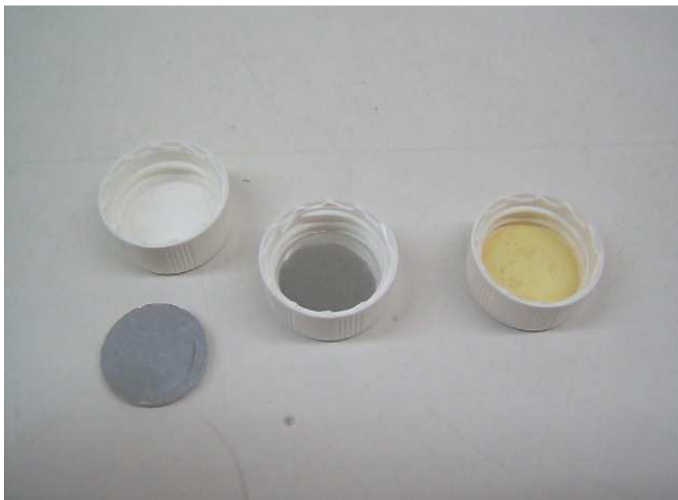
Σχήμα 4.3 - Επίδραση αραιού νιτρικού οξέως στο πλαστικό πώμα των φιαλιδίων τύπου LSC. Δεξιά, το προστατευτικό μαξιλαράκι είναι σε πλήρη αποσύνθεση.
