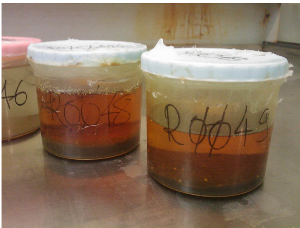
Σχήμα 5.18 - Η ιδιαίτερα ρυπασμένη μήτρα των δειγμάτων βρόχινου νερού «R0048» και «R0049», με την χαρακτηριστική σκούρα απόχρωση και το ίζημα.
