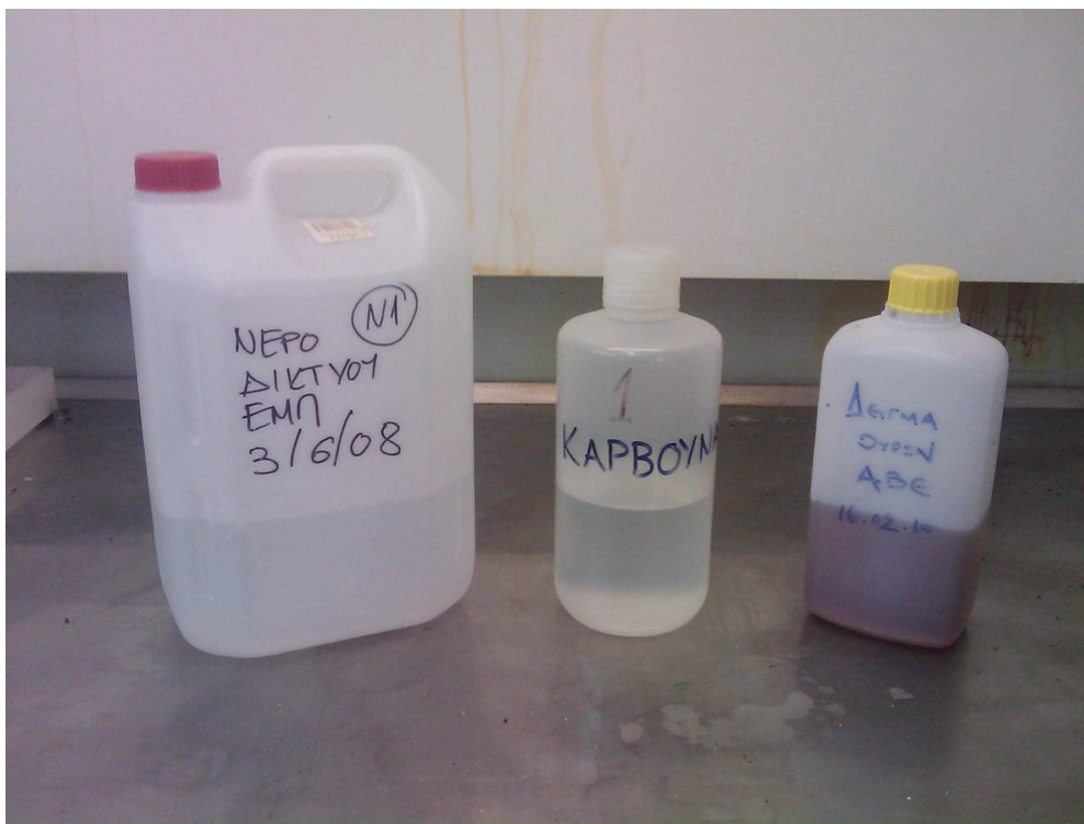
Σχήμα 5.19 - Τα δοχεία συλλογής διαφόρων δειγμάτων στο πλαίσιο του μετρητικού έργου. Το μεσαίο είναι δοχείο πολυαιθυλενίου υψηλής πυκνότητας (HDPE) ειδικό για διατήρηση διαλυμάτων. Τα πλαϊνά είναι απλά πλαστικά δοχεία του εμπορίου.
