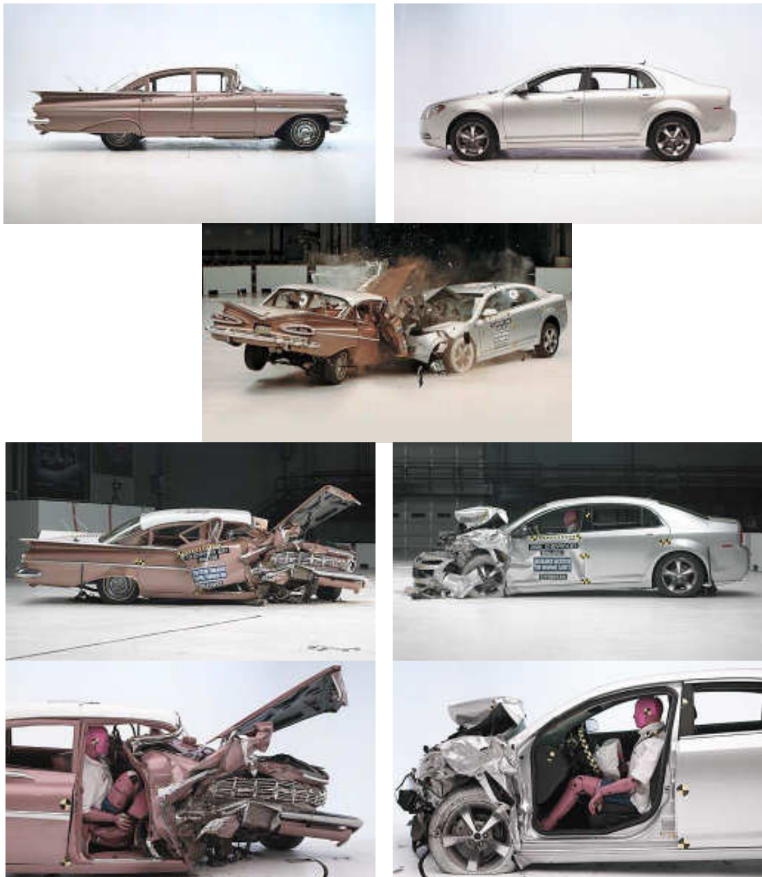
Σχήμα 1.2: Προσομοίωση σύγκρουσης οχήματος κατασκευής 1959 (αριστερά) με όχημα κατασκευής 2009 (δεξιά)
