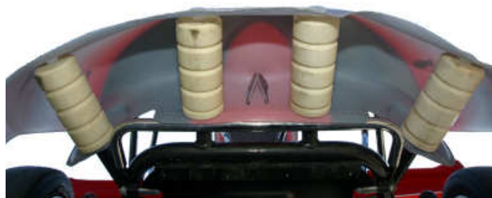
Σχήμα 1.4: Στοιχεία απορρόφησης ενέργειας σε ερασιτεχνικό αγωνιστικό όχημα τύπου kart
