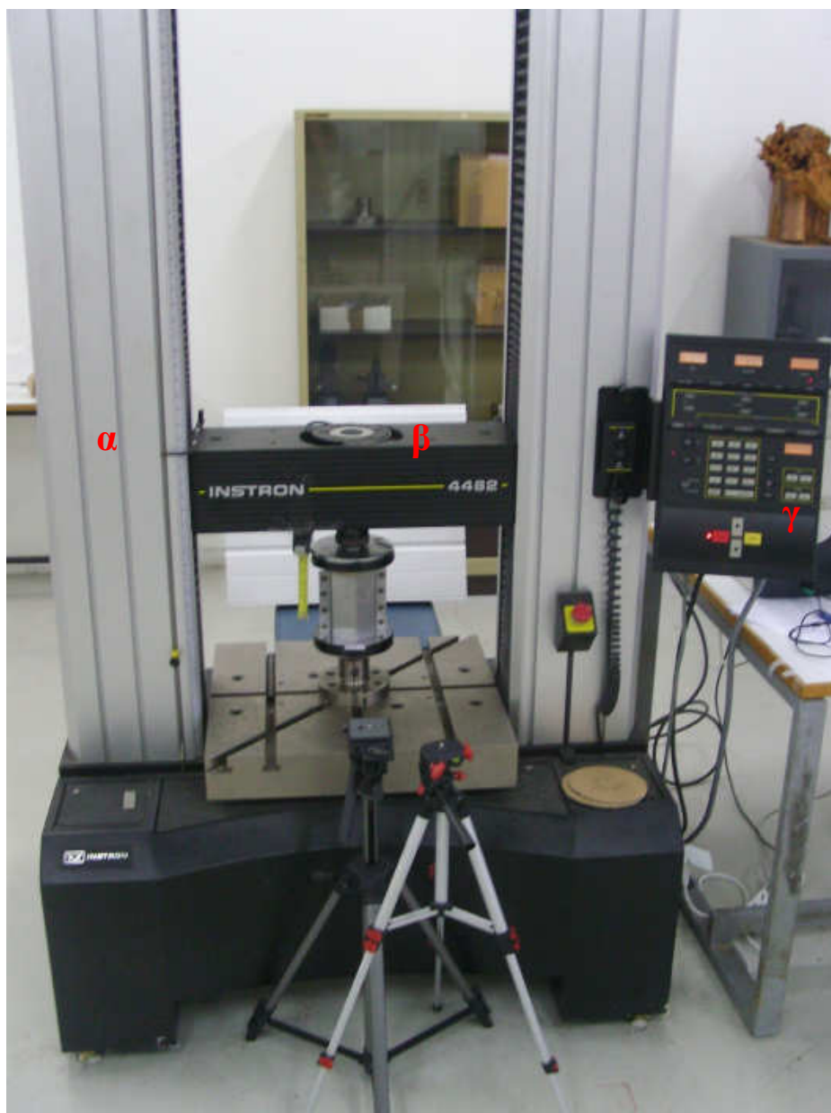
Σχήμα 5.1: Μηχανή δοκιμών Instron 4482 α) πλαίσιο β) κινητή κεφαλή γ)πίνακας ελέγχου
