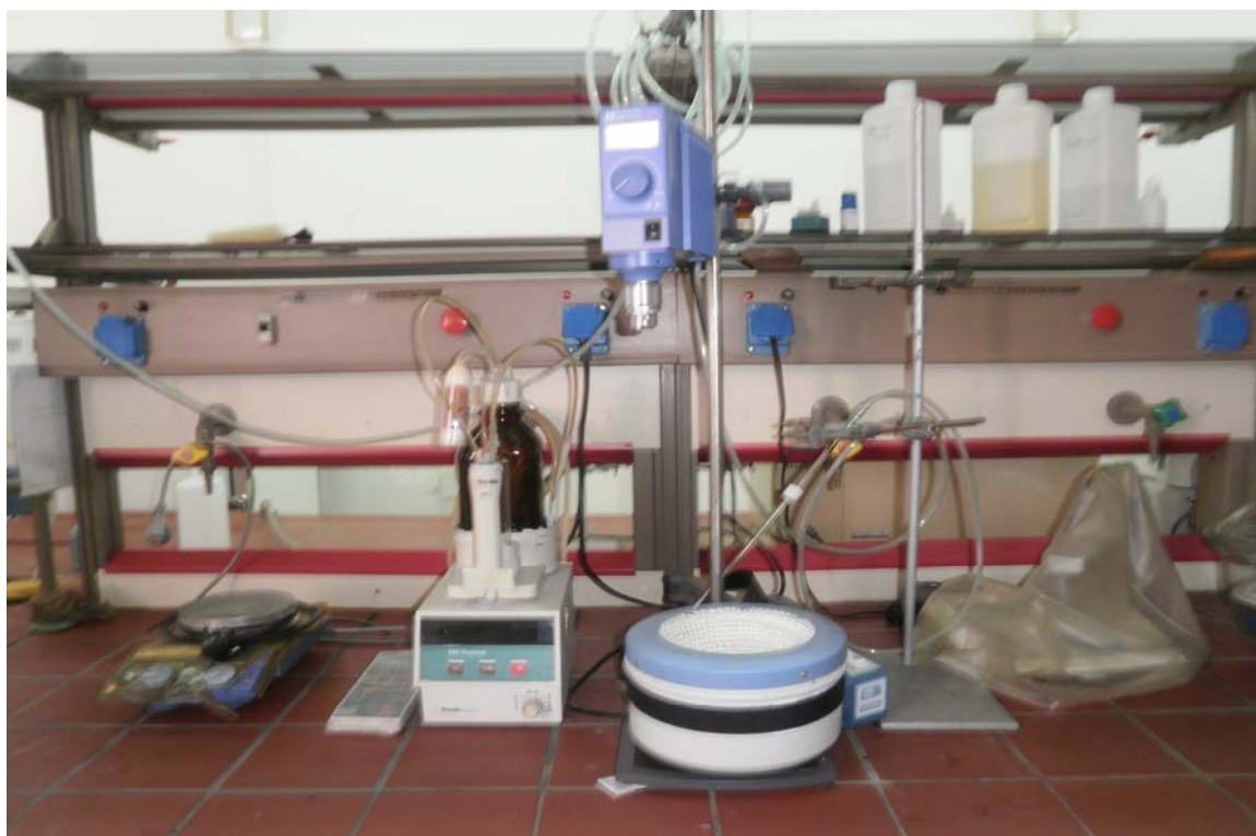
Εικόνα 5.1.β: Δοσομετρητής DOSSIMAT συνδεδεμένος με συσκευή στην οποία εισάγεται και ο αντιδραστήρας.
