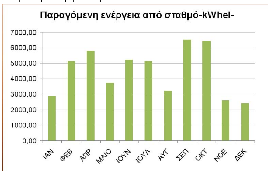
Διάγραμμα 4.6: Παραγόμενη ενέργεια από Φ/Β σταθμό ανά μήνα λειτουργίας (μετεω. δεδομένα 2008, μεταβλητή κλίση)
