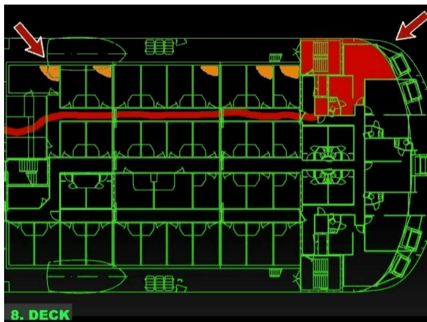
Σχήμα 7.30: Στιγμιότυπο της πορείας πετρελαίου στο deck 8, περιοχή πλώρης.
