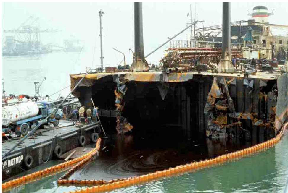
Σχήμα 3.5: Το προμναίο τμήμα του Tanio μέσα στο λιμάνι της Χάβρης περιβαλλόμενο από αντιρρυπαντικά φράγματα.
