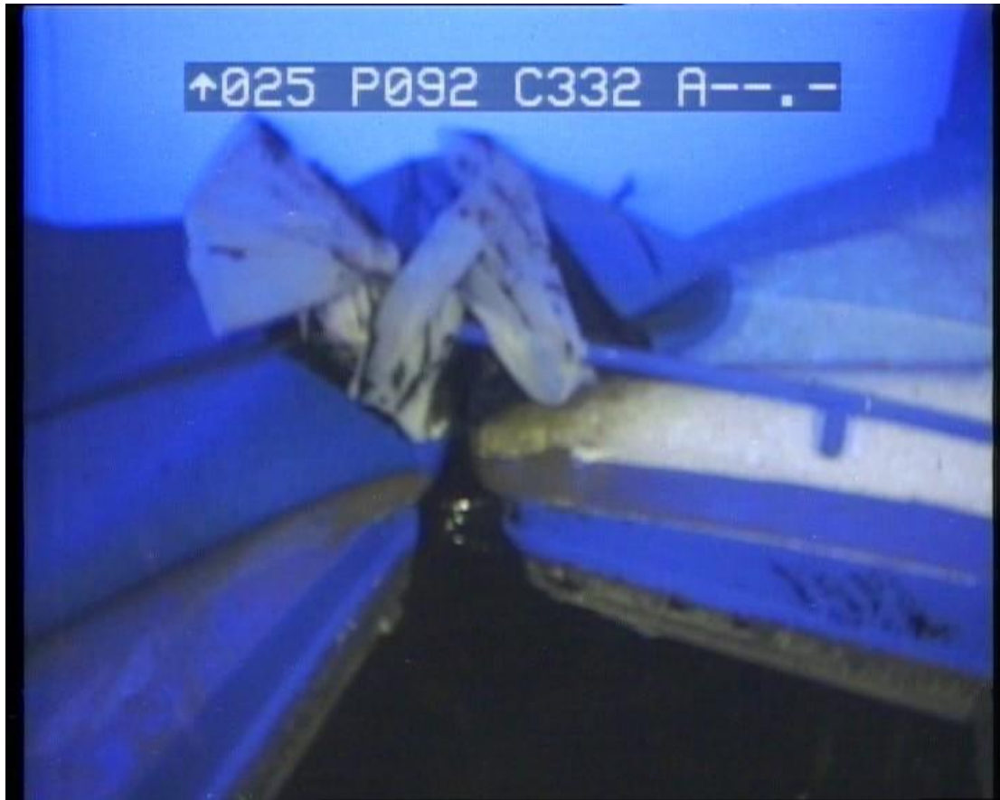
Σχήμα 7.17: Λεπτομέρεια διαρροής από παράθυρο στο deck 7.
