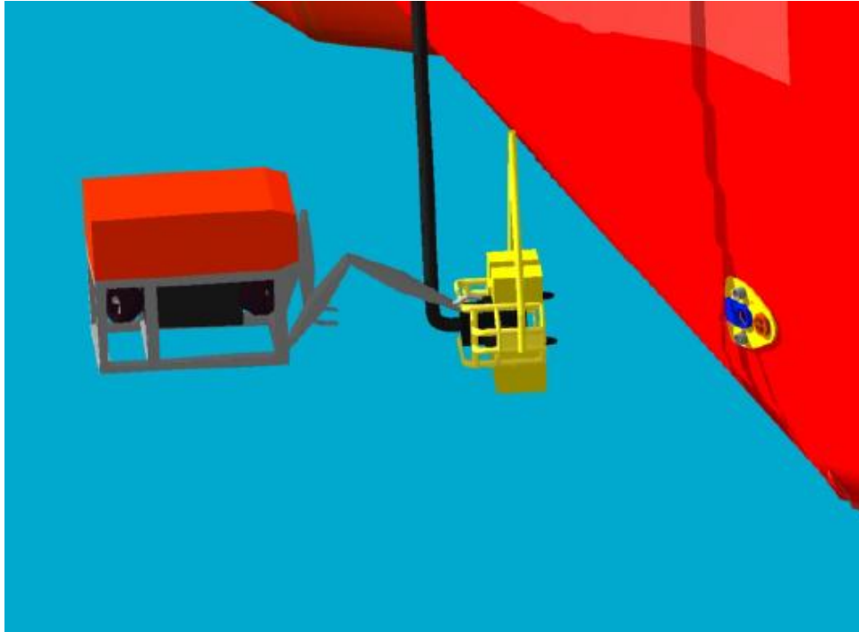
Σχήμα 5.12: Το ROLS έτοιμο για απάντληση.
