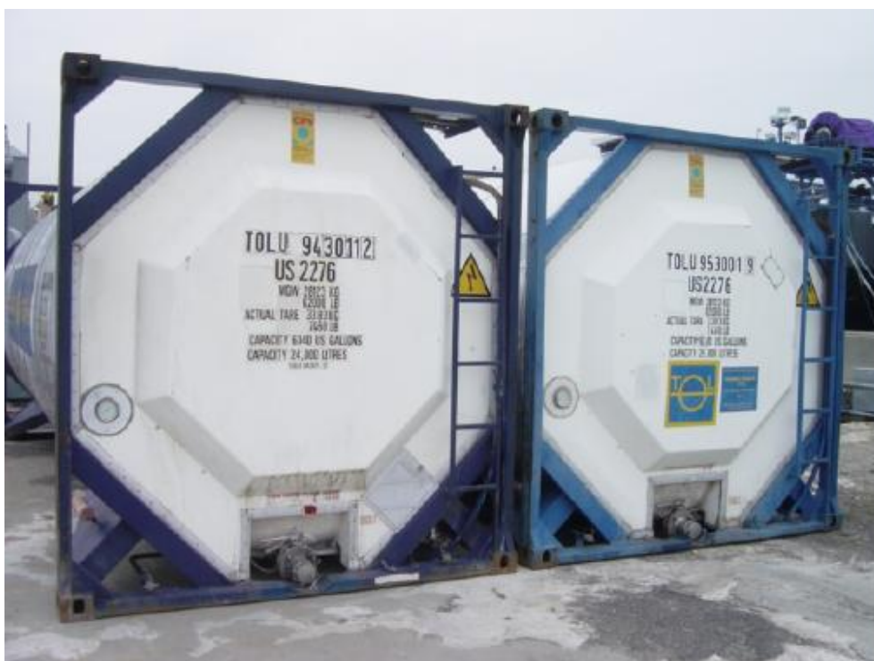
Σχήμα 5.17: Δεξαμενές μεταφοράς πετρελαιοειδών.
