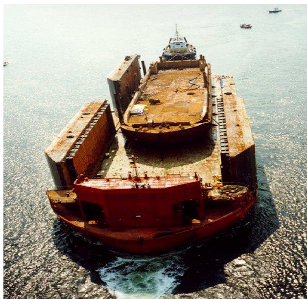
Σχήμα 2.13: Το Irving Whale φορτωμένο πάνω στο Boabarge 10
