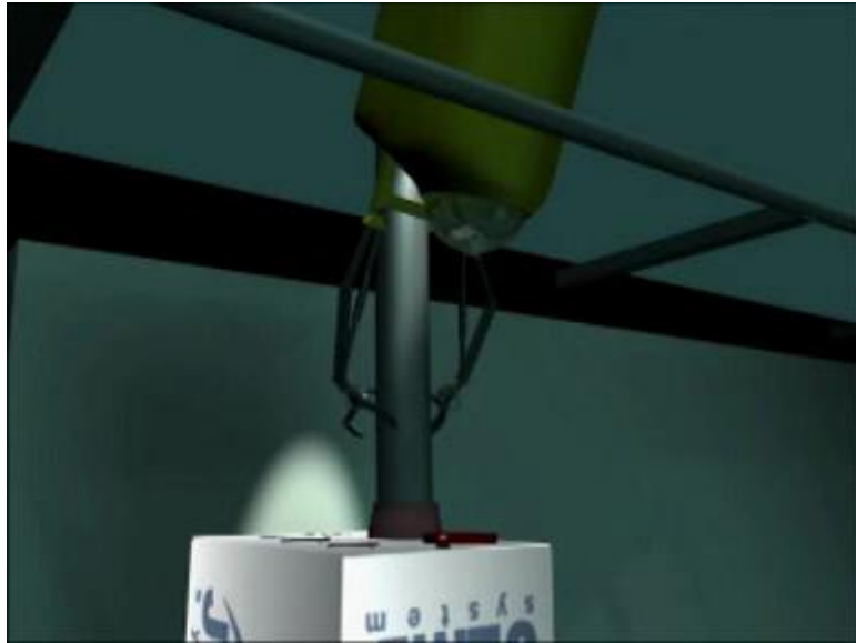
Σχήμα 6.15: Πρόσβαση του ROV στον κλωβό εξόδου των σωληνώσεων.
